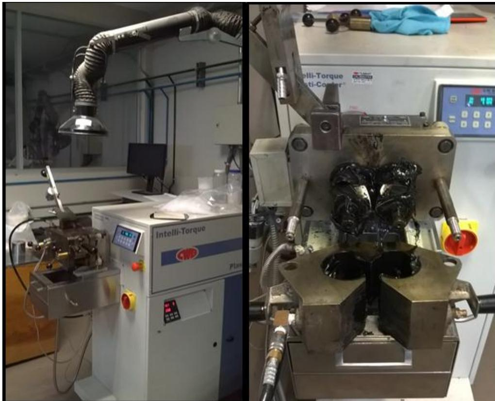
Figura 3.6. Mezclador interno Brabender. A la izquierda: el equipo encendido. A la derecha: la cámara abierta justo al finalizar un ciclo de operación.
