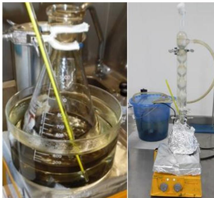
Figura 3.5. A la izquierda: Oxidación del grafito a alta temperatura. A la derecha: Sistema con reflujo para la reducción de óxido de grafeno.
