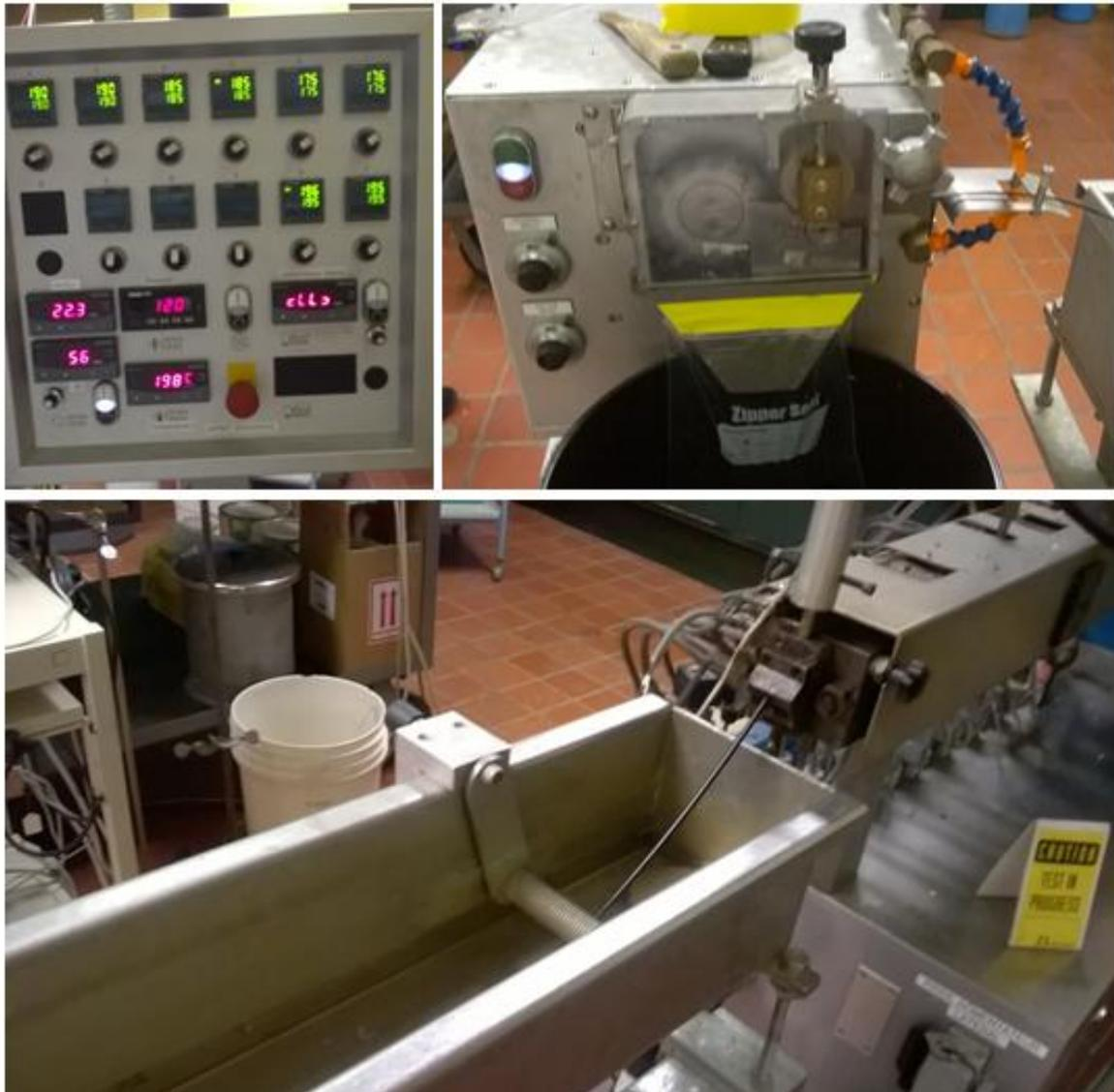
Figura 3.7. Parte superior izquierda: Panel de temperaturas del extrusor doble husillo Leistritz ZSE 18HP. Parte superior derecha: Peletizadora Scheer Bay BT 25. Parte inferior: Extrusor doble husillo Leistritz.
