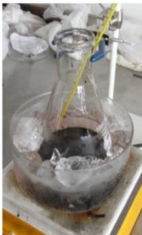
Figura 3.4. Oxidación del grafito a baja temperatura.
