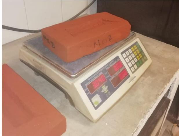
*Fig. 4. 41 Obtención del peso de la pieza después de ser retirada del recipiente con agua.*
