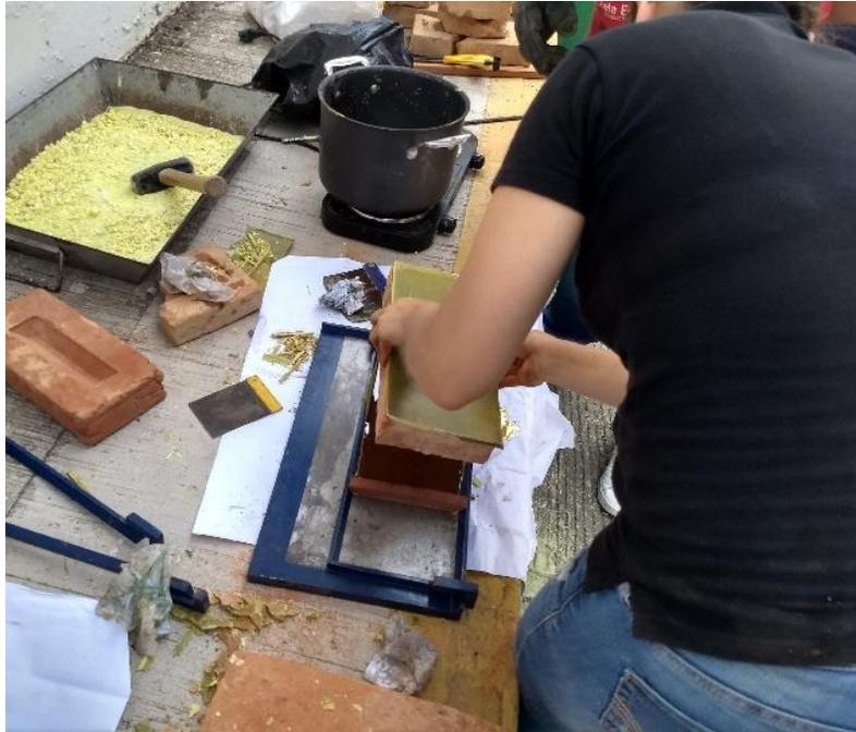
*Fig. 4. 53 Encarado de una pieza de tabique.*
