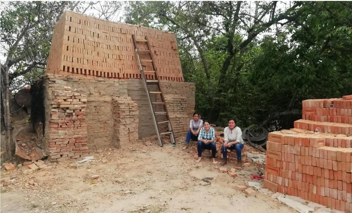
*Fig. 1. 20 Horno con piezas después de su cocción.*
