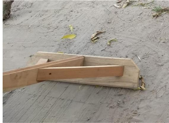
*Fig. 1. 25 Rastrillo empleado para la preparación del terreno.*
