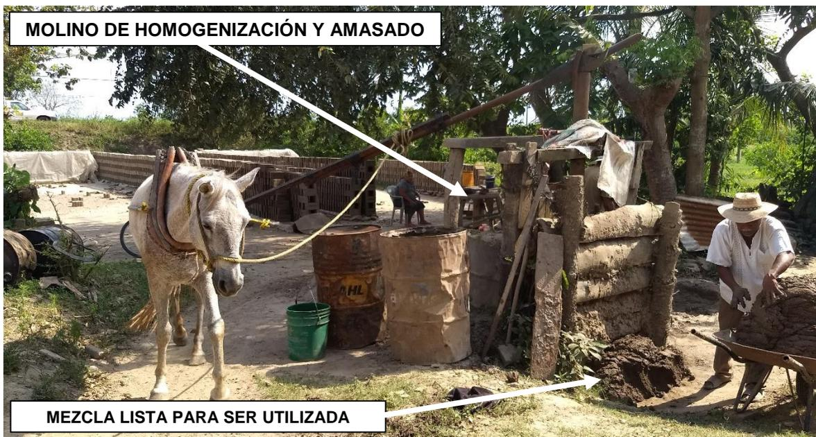
*Fig. 2. 10 Material amasado y homogenizado.*
