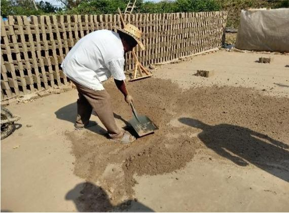
*Fig. 2. 13 Preparación del terreno para secado de las piezas.*
