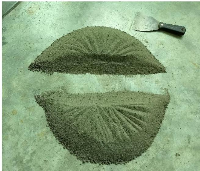
*Fig. 4. 17 El cono truncado se divide primeramente en dos secciones.*
