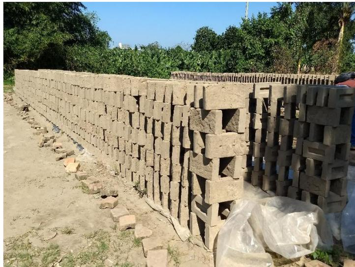
*Fig. 2. 20 Estibación para secado, previa a la cocción de las piezas.*
