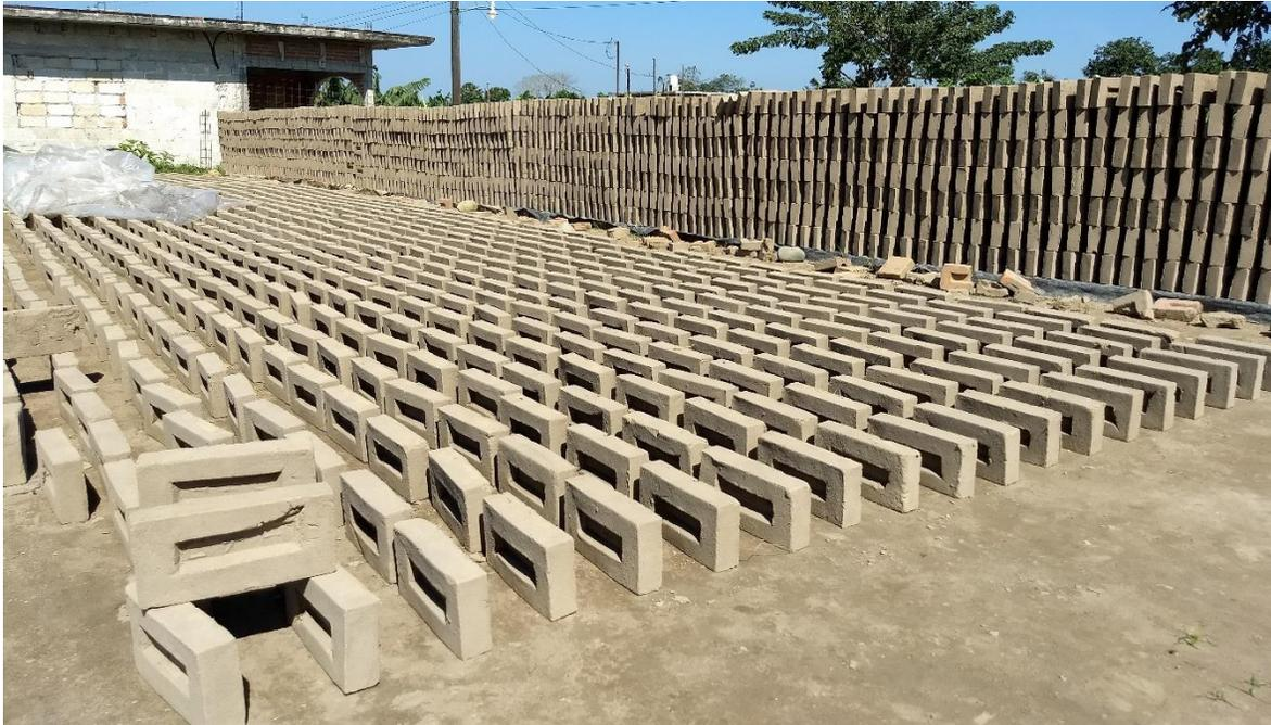
*Fig. 2. 19 Secado de las piezas tomando de base uno de sus cantos (esto se realiza después de haber transcurrido alrededor de dos días de secado dependiendo del estado climatológico).*
