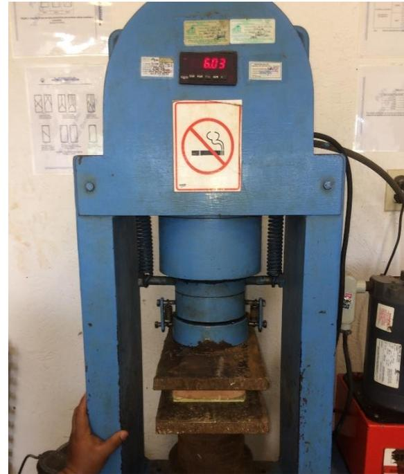
Fig. 4. 61 Prensa de compresión con marcador digital de la resistencia obtenida de la pieza.
