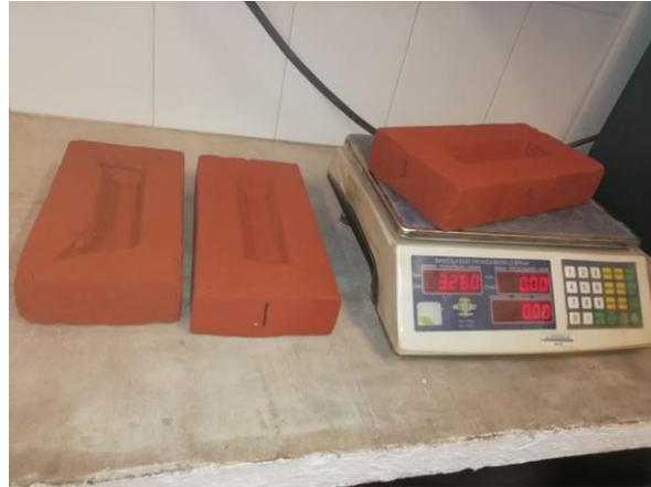
*Fig. 4. 45 Obtención de la masa de las piezas después del secado.*
