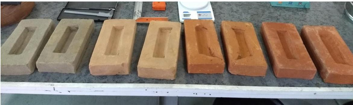
*Fig. 1. 6 Ejemplo de tabiques o ladrillos en diferentes niveles de cocción.*
