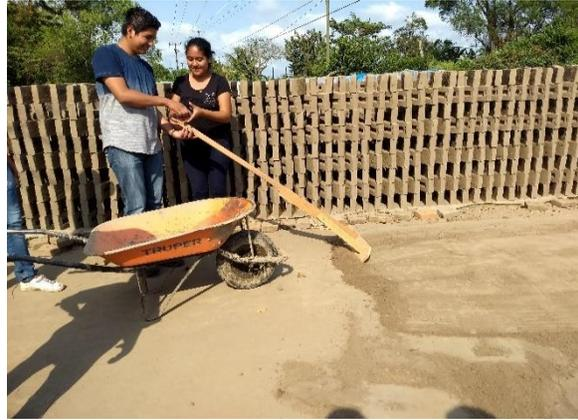
*Fig. 2. 14 Colocación de cama de arena para evitar que las piezas se adhieran al suelo.*
