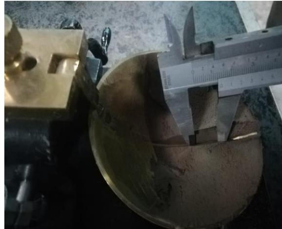
*Fig. 4. 9 Verificación de que la junta esté cerrada a 13 milímetros.*
