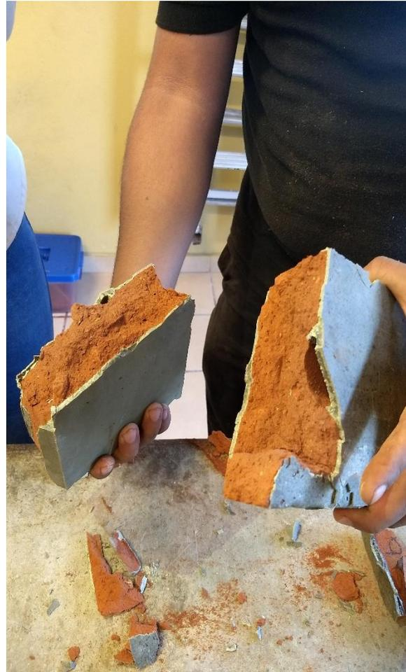
*Fig. 5. 2 Pieza después de someterse a la prueba de compresión axial.*
