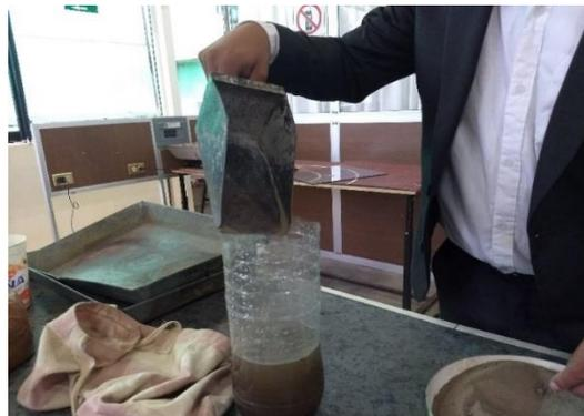
*Fig. 4. 2 Lavado de material para la prueba de granulometría.*
