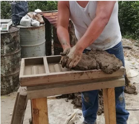
*Fig. 3. 9 Moldeado de material para determinar el peso y obtener el peso de los porcentajes de cemento adicionante.*
