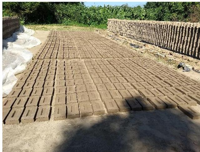
*Fig. 1. 11 Patio de secado y de estibación de las piezas.*
