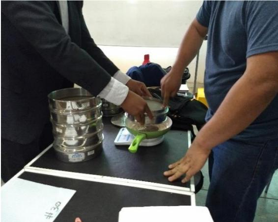
Fig. 4. 5 Pesaje del material retenido en cada uno de los tamices.
