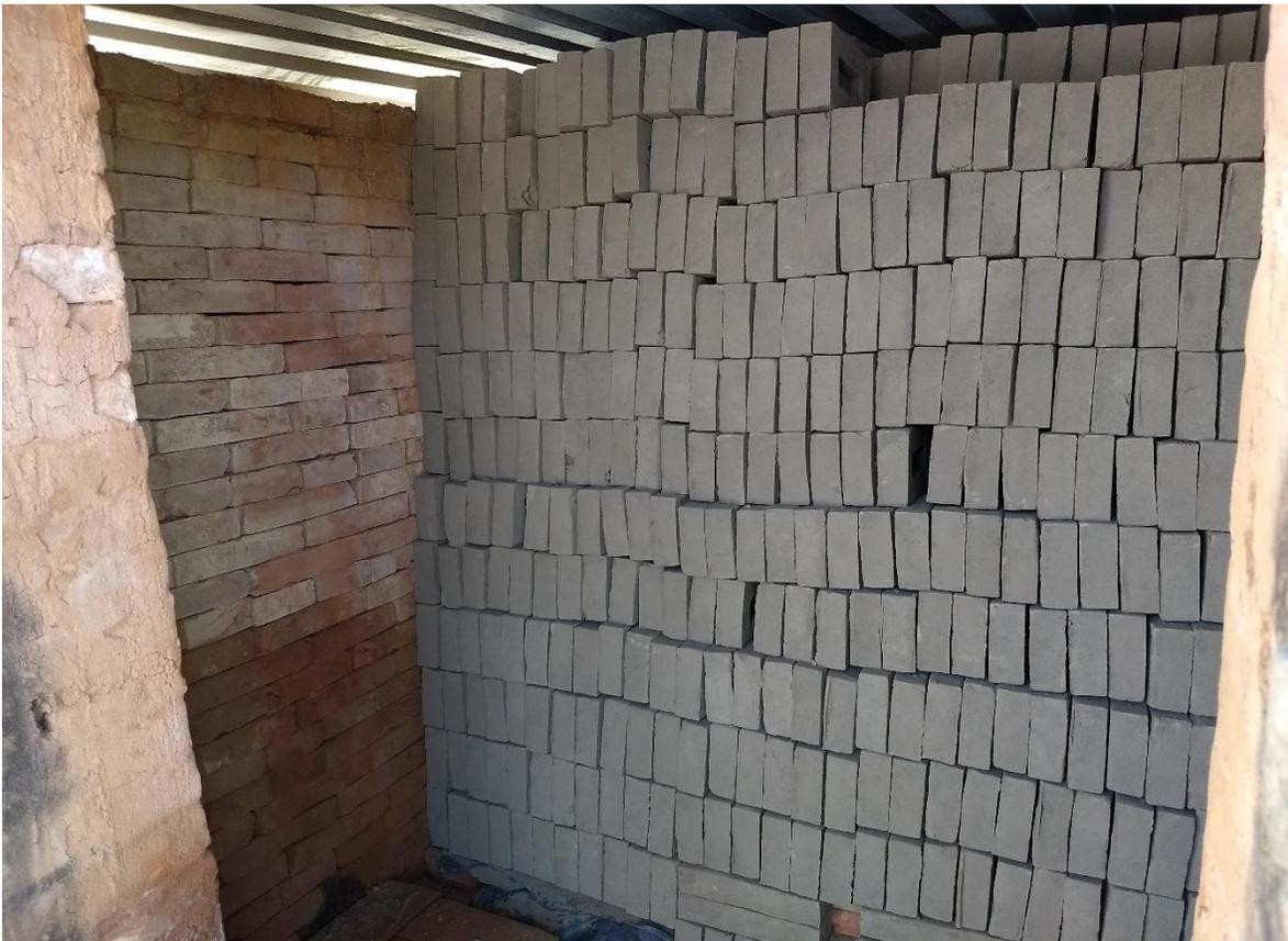
*Fig. 2. 21 Estibación dentro del horno para su cocción.*
