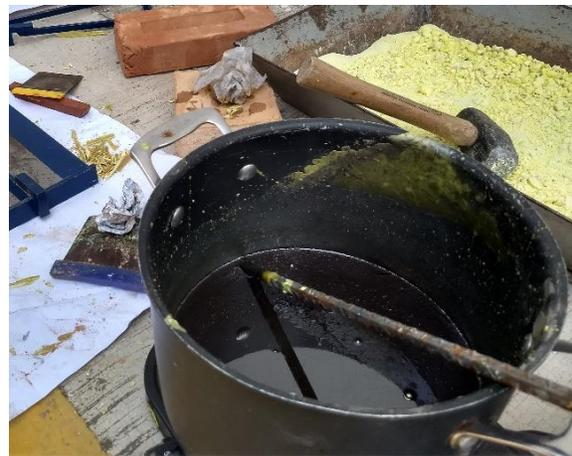
*Fig. 4. 49 Azufre en estado líquido después del proceso de fundición.*
