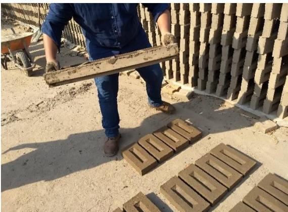
*Fig. 2. 17 Correcta elaboración y desprendimiento de las piezas.*
