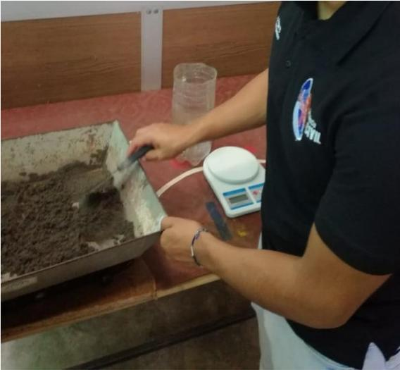
Fig. 4. 26 Secado de la muestra de arena.
