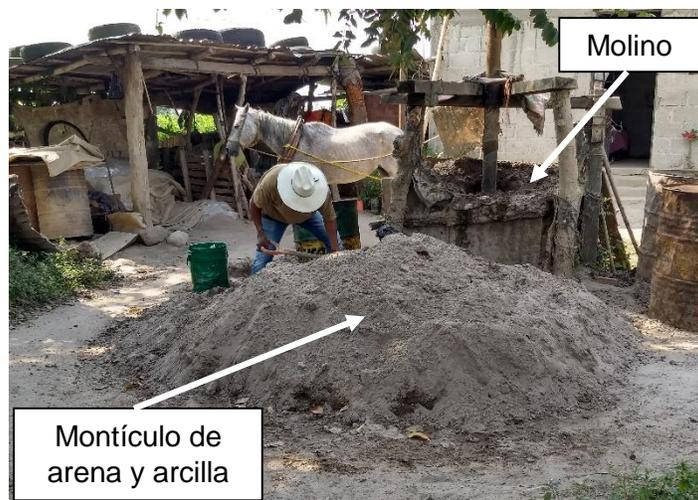
*Fig. 2. 8 Preparación de arcilla y la arena para ser vertida al molino.*
