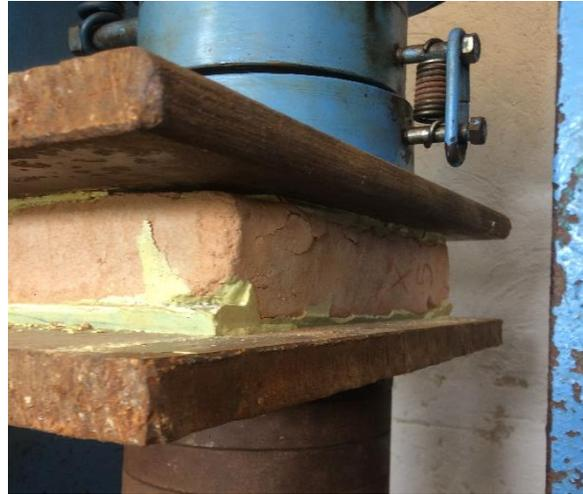
Fig. 4. 59 Desprendimiento de material al ejercerle presión a la pieza.
