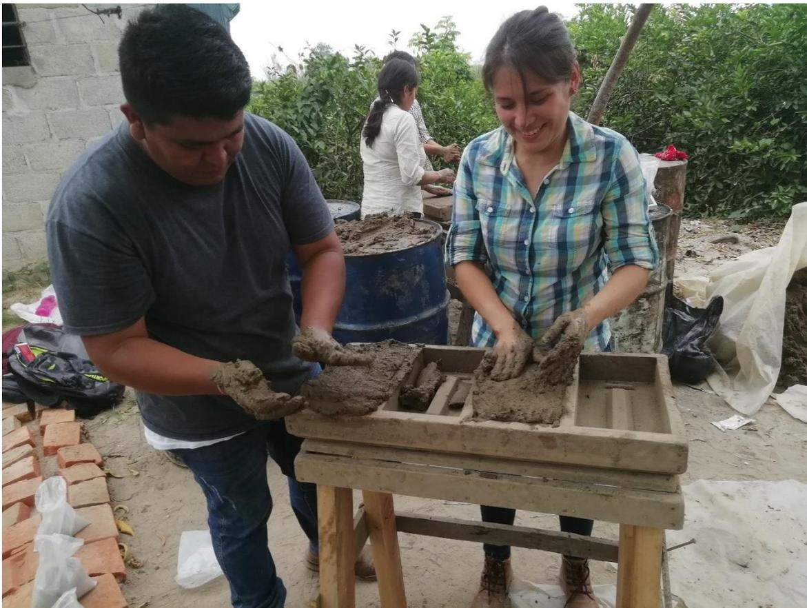
*Fig. 3. 1 Colocación de material sobre la gavera.*
