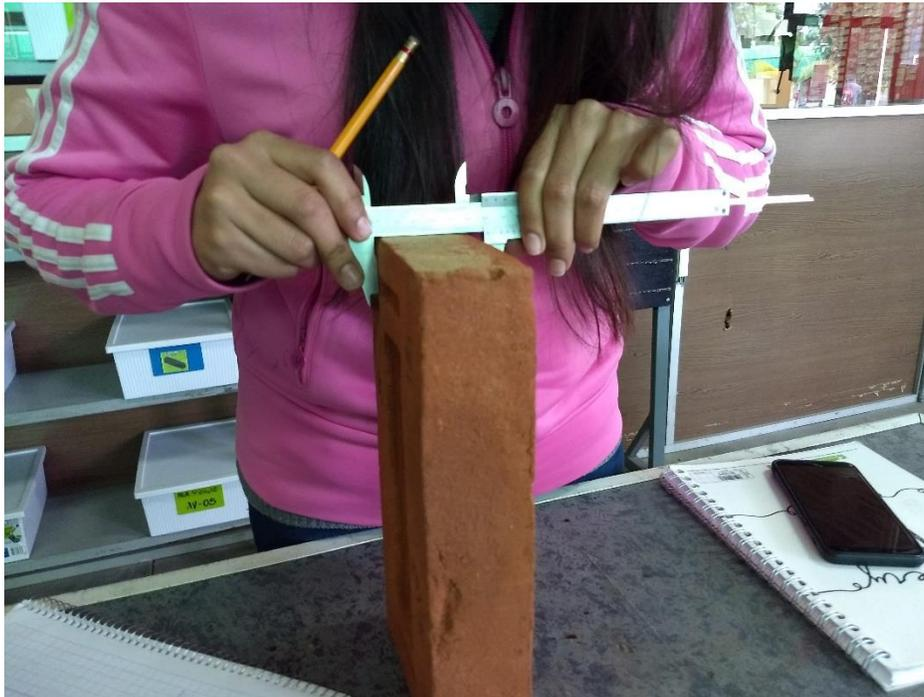
*Fig. 4. 35 Medición del grueso de una pieza de tabique.*
