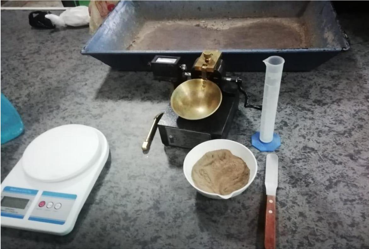
*Fig. 4. 8 Materiales a utilizar para la prueba de limite líquido.*
