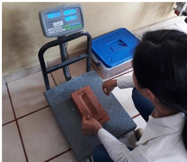
Fig. 4. 38 Obtención de la masa de la pieza de tabique.
