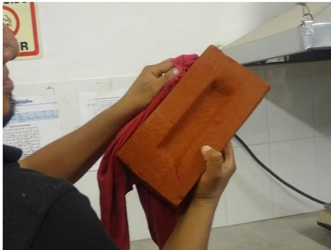
*Fig. 4. 40 Retiro del exceso de agua de la pieza de tabique.*
