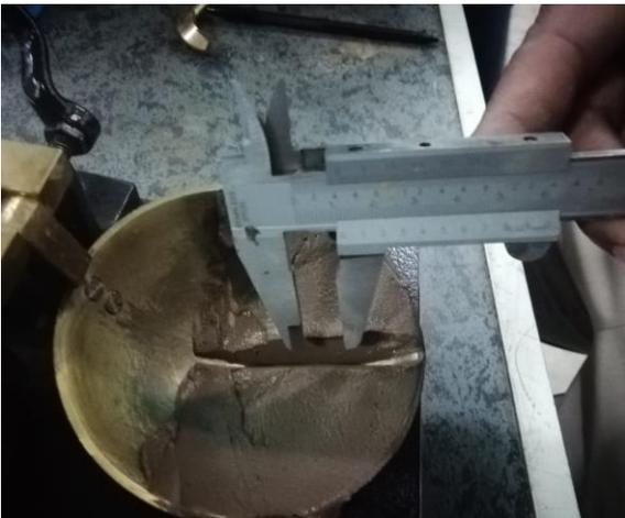
*Fig. 4. 7 Medición de la abertura después de ejecutar los golpes indicados.*
