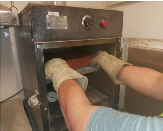
*Fig. 4. 42 Colocación de las piezas dentro del horno de secado.*
