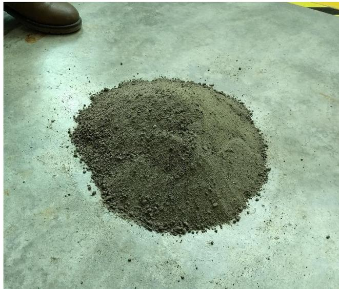
*Fig. 4. 14 Montículo de arena en estado seco para proceder al cuarteo.*
