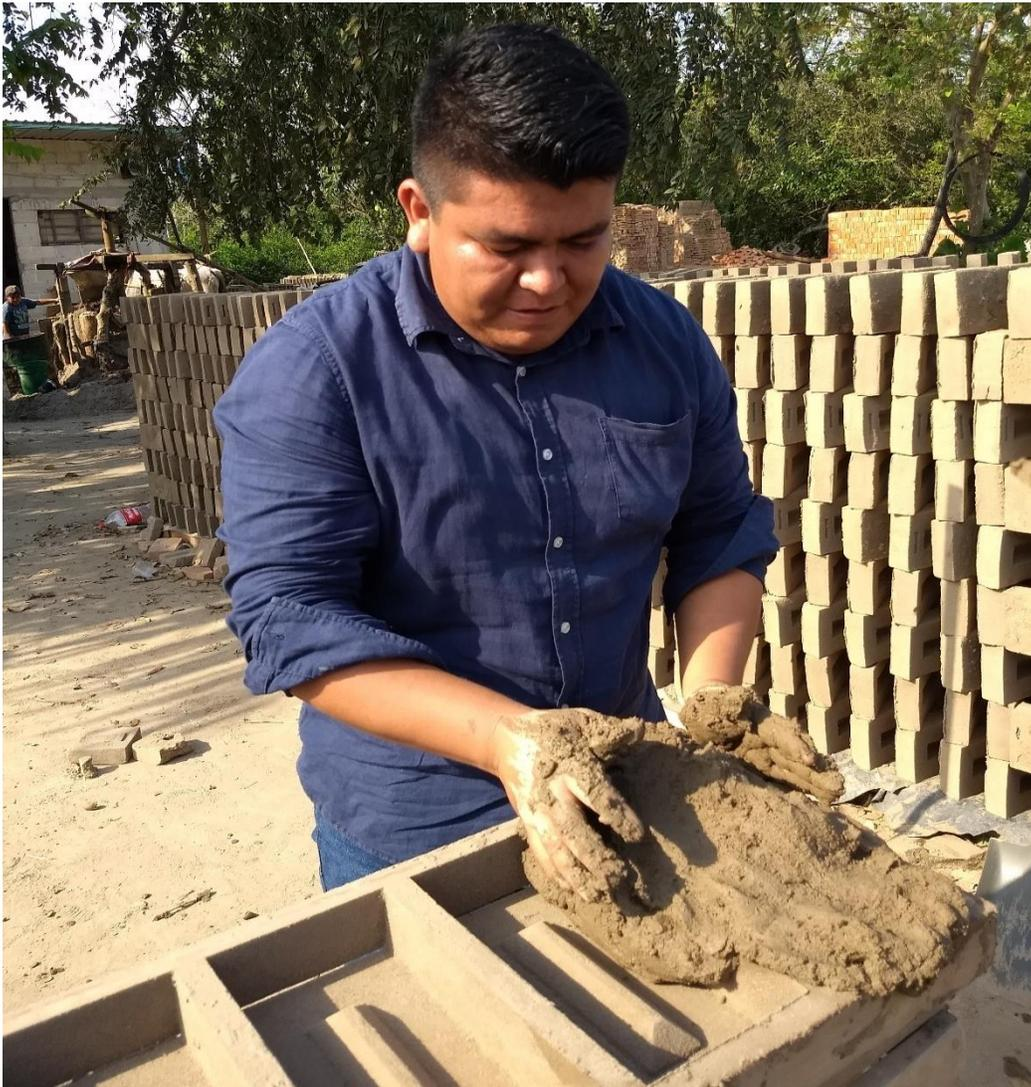
*Fig. 4. 1 Proceso de moldeado de los tabiques dentro de la gavera.*
