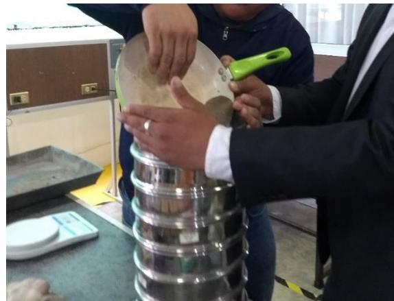
*Fig. 4. 4 Proceso de cribado del material.*
