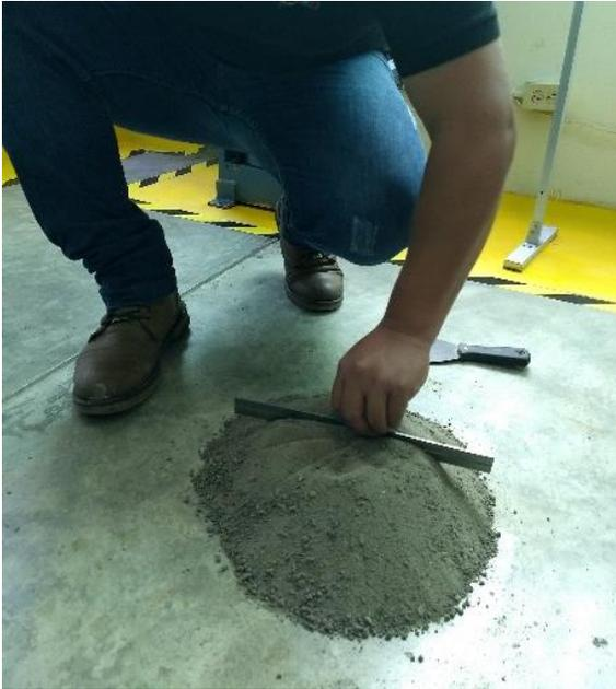
*Fig. 4. 15 El montículo destendido con golpes continuos con uno de los filos de la regla.*
