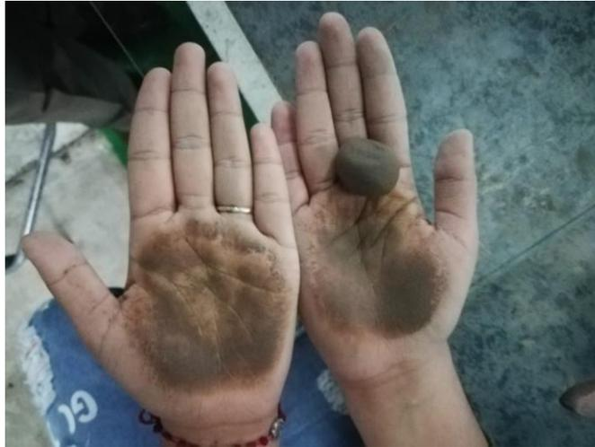
*Fig. 4. 10 Amasado para cilindros de arcilla.*
