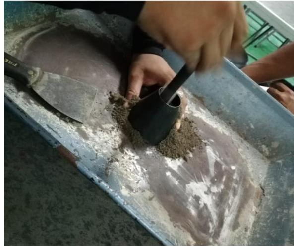
Fig. 4. 29 Compactación del material dentro del cono.
