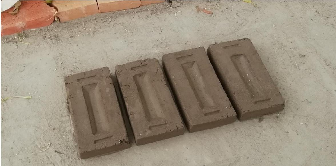
*Fig. 3. 23 Primeras piezas obtenidas en estado fresco de la adición de Cemento Portland.*
