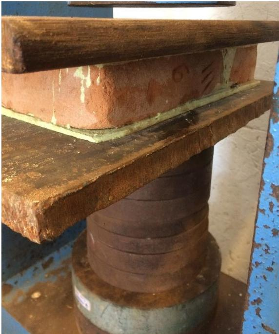
Fig. 4. 60 Colocación de calzas (placas de acero) para alcanzar el pistón de la prensa.
