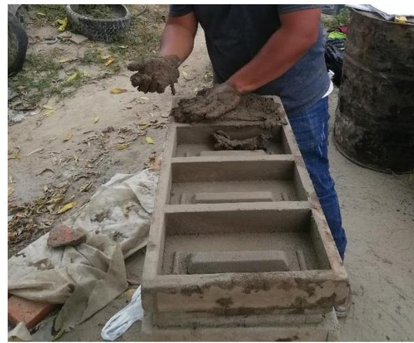
*Fig. 3. 13 Colocación de la mezcla dentro de la gavera.*
