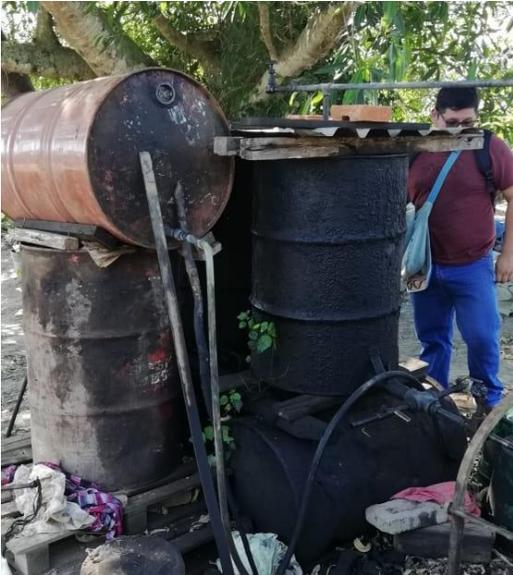
*Fig. 1. 21 Combustible para llevar acabo la cocción de las piezas de tabique.*
