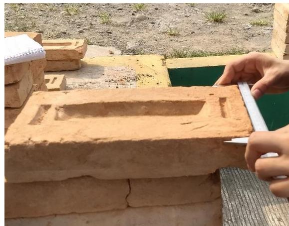
*Fig. 3. 22 Pieza con adición de cemento después de su cocción.*
