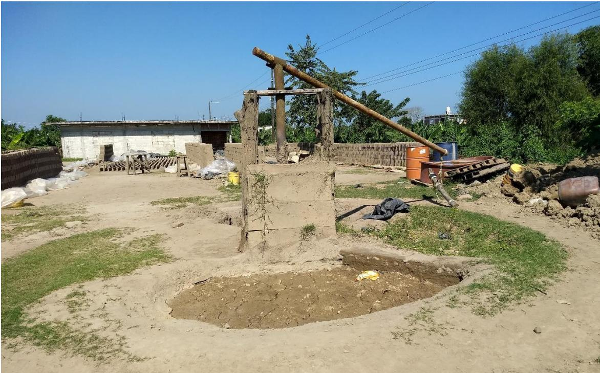
*Fig. 1. 27 Molino de tracción animal de la tabiquera Ortega.*
