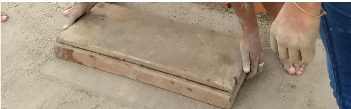
*Fig. 3. 21 Colocación de las piezas en el patio de secado.*
