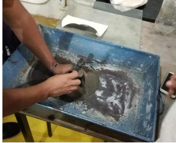
*Fig. 4. 31 Enrase del cono para retirar exceso de material.*
