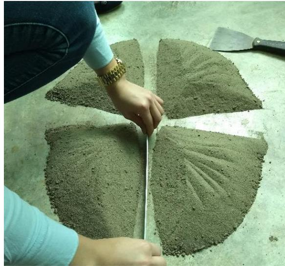
*Fig. 4. 20 Resultado del cuarteo del cono truncado.*
