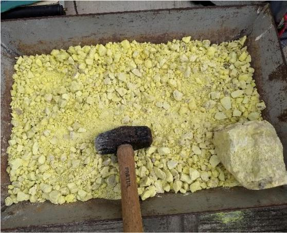
*Fig. 4. 46 Trituración manual del azufre.*
