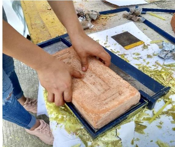
*Fig. 4. 51 Colocación de la pieza sobre el azufre líquido.*
