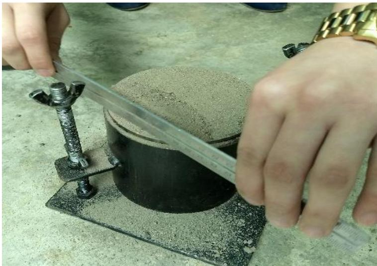
Fig. 4. 25 Enrasado de molde para retirar material excedente.
