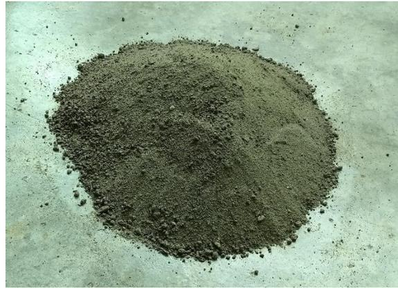
*Fig. 1. 15 Cono de arena para realizar cuarteo y poder determinar el peso volumétrico seco suelto.*
