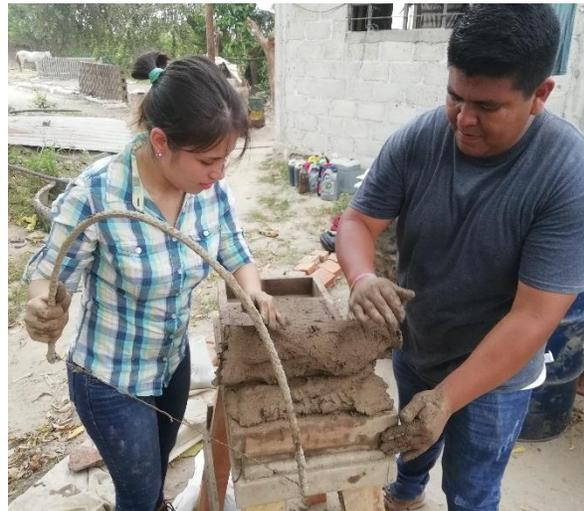
*Fig. 3. 10 Retiro de exceso de material de la gavera.*
