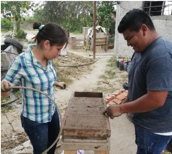
*Fig. 3. 12 Moldeado de material para determinar el peso y obtener el peso de los porcentajes de cemento adicionante.*
