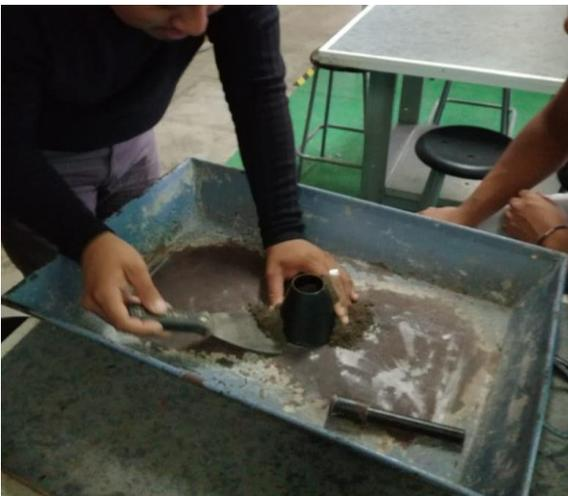
Fig. 4. 28 Llenado del cono con material.
