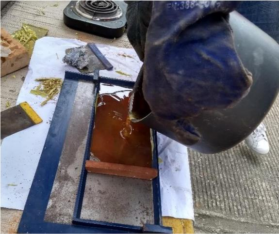
*Fig. 4. 50 Colocación del azufre líquido sobre la cabeceadora.*
