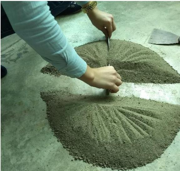
*Fig. 4. 19 Segmentación de las dos partes en las que se dividió el cono truncado.*
