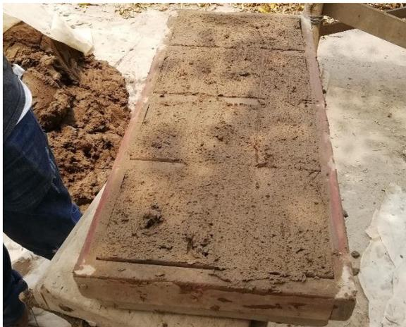
*Fig. 3. 17 Piezas enrasadas listas para colocarse en el patio de secado.*
