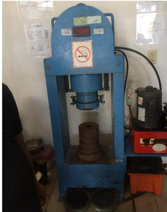
*Fig. 4. 54 Prensa para compresión axial del laboratorio LACOCA (Laboratorio de control de calidad).*
