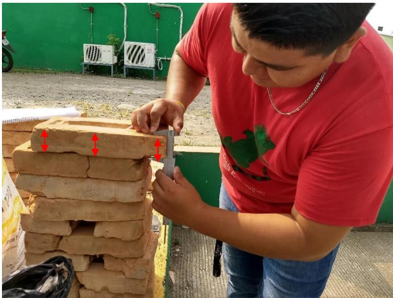
*Fig. 4. 37 Medición del grueso de la pieza de tabique.*
