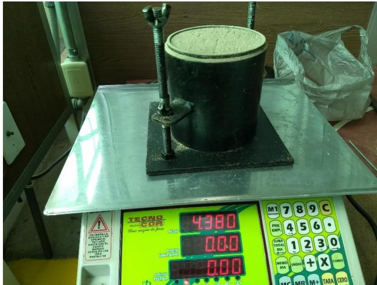
Fig. 4. 24 Pesaje del molde con material.
