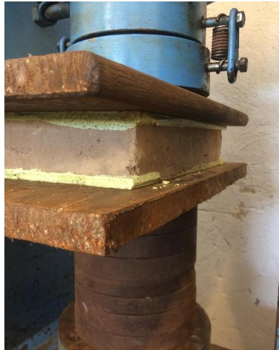
Fig. 4. 56 Tabique sometido a compresión axial.
