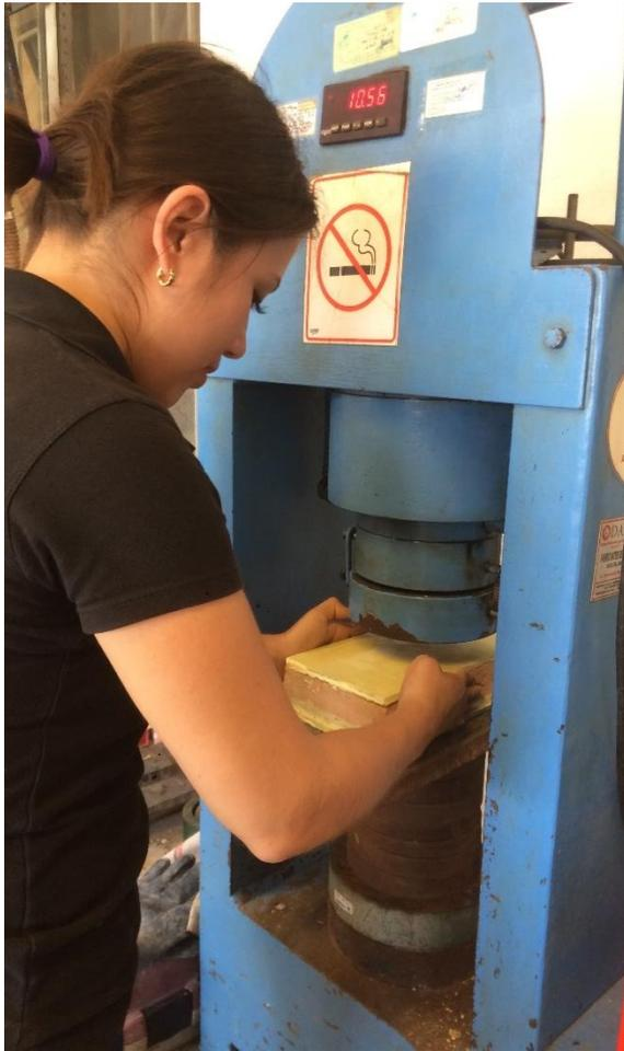
*Fig. 5. 1 Colocación de la pieza en la prensa de compresión axial.*
