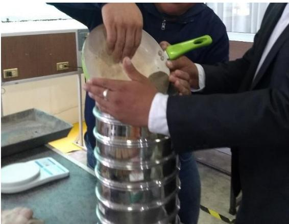
*Fig. 4. 3 Proceso de cribado del material seco.*
