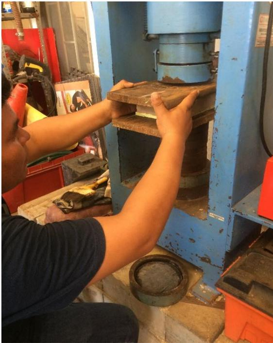
Fig. 4. 55 Colocación de la pieza de tabique sobre la prensa.
