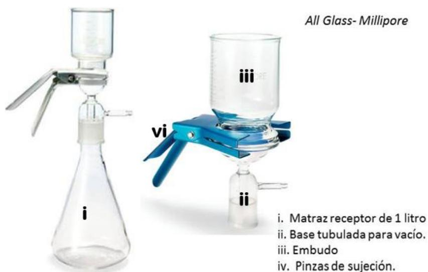
**Figura 3.2** Sistema de filtración
