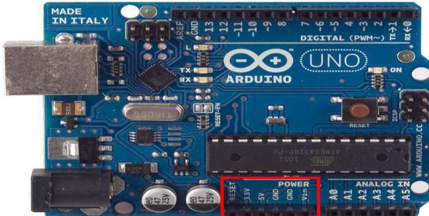
FIGURA 2.14 Pines de alimentación. (Power Pins).
