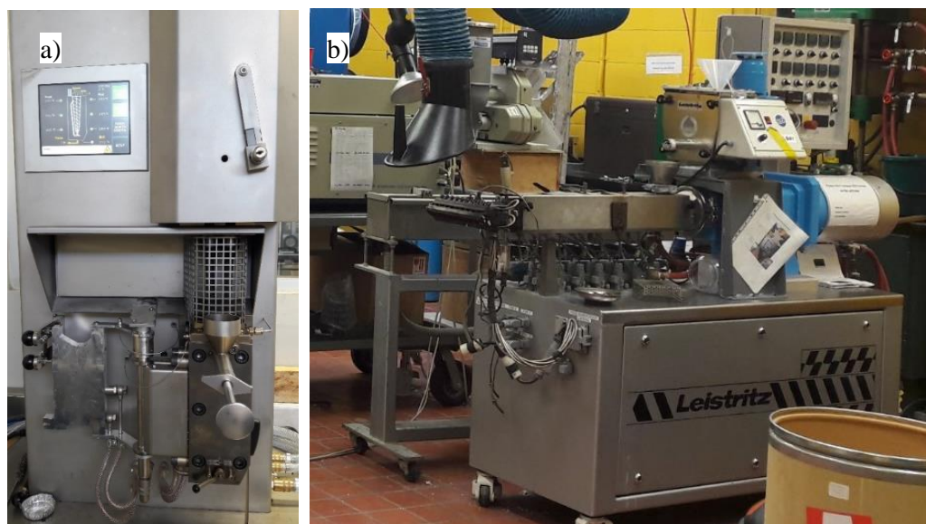
Figura 2.6 a) Extrusor XPLORE utilizado para la preparación de concentrados y b) extrusor Leistritz empleado para la obtención del material compuesto.
