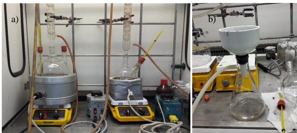
Figura 2.5 a) Sistema de reflujo empleado en las funcionalizaciones y b) proceso de filtración.
