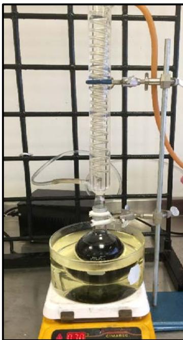
**Figura 3.6.** Proceso de funcionalización del óxido de grafeno.
