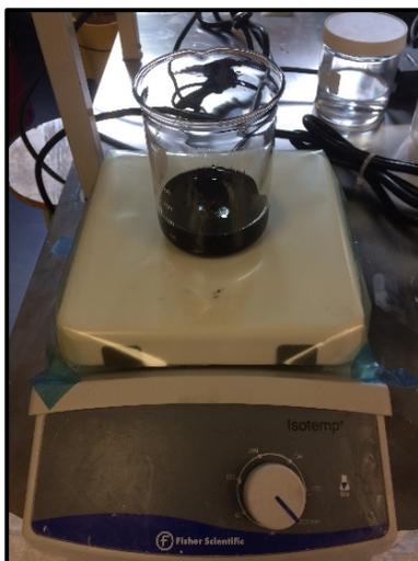
**Figura 3.7.** Mezclado por agitación magnética de las nanopartículas con al agente de curado.
