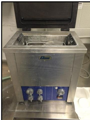
**Figura 3.8.** Mezclado por ultrasonido de las nanopartículas con al agente de curado.
