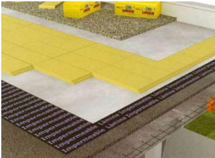
Ilustración 2.2.- detalle de colocación poliestireno extruido (EXP).
