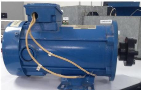
Figura 14. Generador cd de imanes permanentes.
