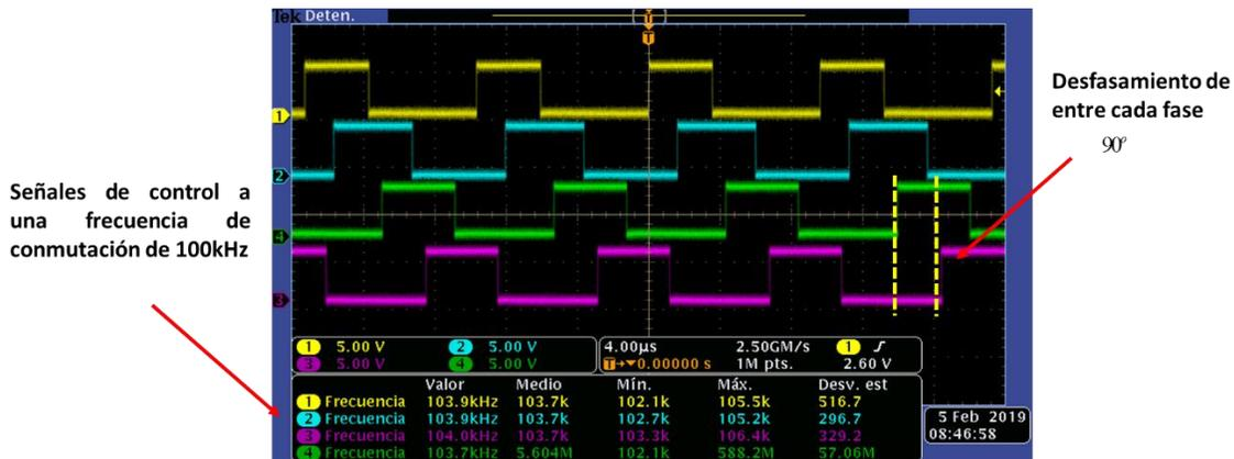
Figura 51. Revisión de pulsos de conmutación del control ISL6558.
