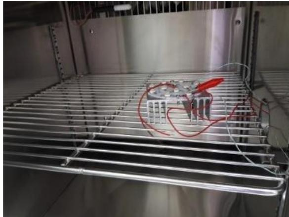
Figura 20. Dispositivo LED dentro de la cámara ambiental.
