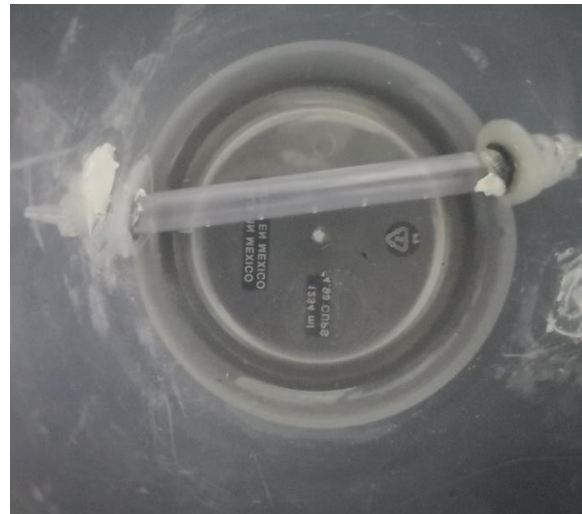
Figura 3.6 Cortina de burbujas en el interior del reactor
