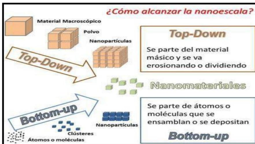
Figura 11. Técnicas de síntesis de nanopartículas (Sánchez et al., 2020)
