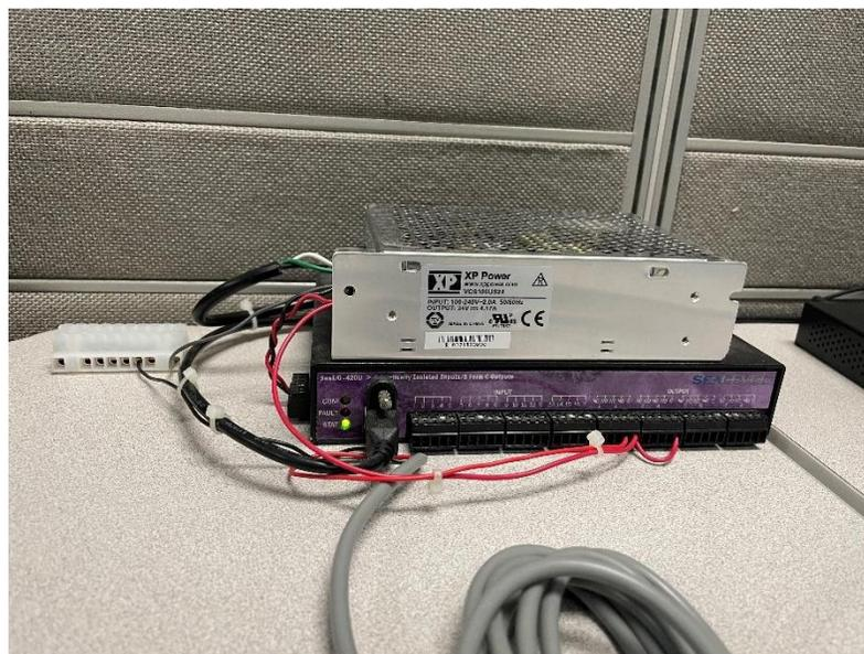
Figura 5.26 Conexiones de SeaLevel 420U y XP Power Supply
