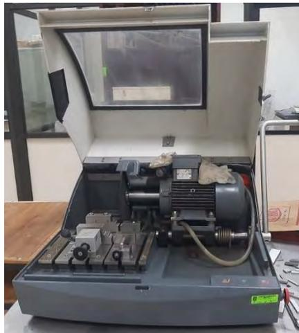
**Figura A.2** Cortadora metalográfica.
