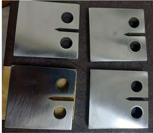
Figura 5.5 Probetas pulidas.
