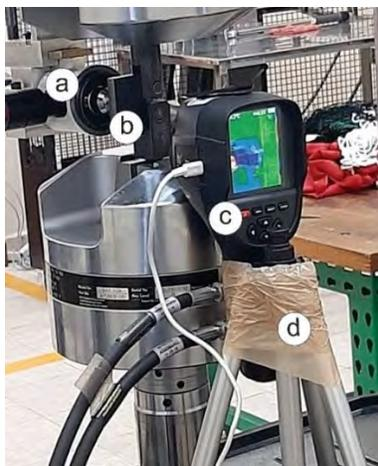
**Figura 5.10** Configuración con cámara termográfica. a) Microscopio, b) Probeta, c) Cámara termográfica, d) Tripié.
