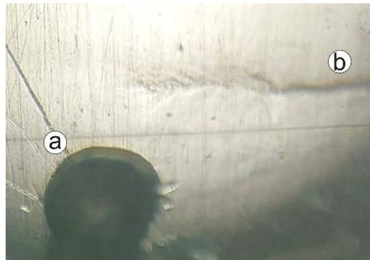
**Figura 5.12** Observación del microscopio con aumento de 40x. a) Termopar, b) Grieta.
