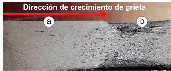
**Figura 6.2** Superficie fracturada de probeta CT. a) Región de propagación de grieta, b) Región de crecimiento inestable de grieta.
