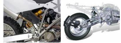
Figura 6.53: Sistema de suspensión y amortiguamiento de una motocicleta.
