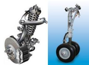
Figura 6.51: Sistemas de amortiguamiento.
