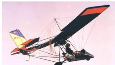
Figura 6.74: Pequeño aeroplano con tensores.
