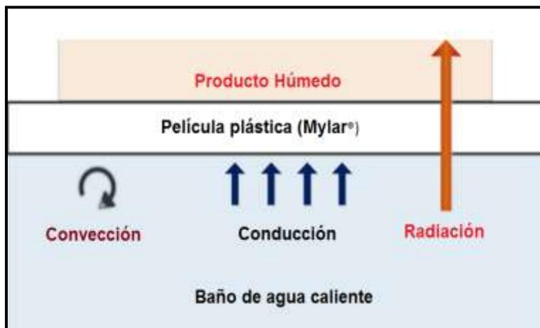
Figura 1. Mecanismo de transferencia de calor del baño de agua caliente al producto alimenticio en el secador RW™ (Ortiz- Jerez et al., 2015).
