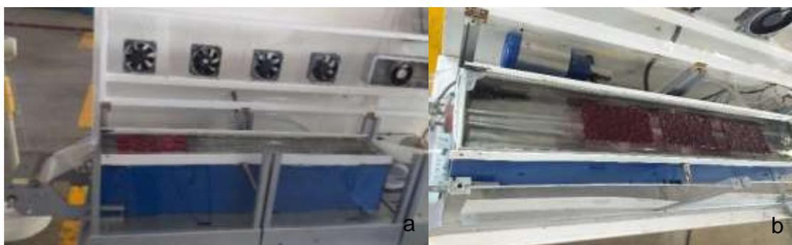
Figura 6. Secado del betabel a) en rodajas y b) semisólido por RW™
