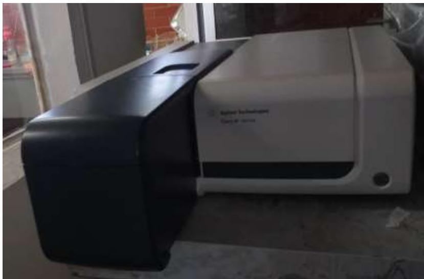
Figura 9. Espectrofotómetro Cary 60 UV Vis.
