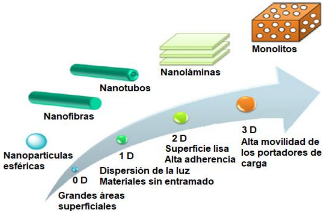
Figura 2.28 Ilustración esquemática de la dimensionalidad estructural de los materiales y las propiedades esperadas de acuerdo con su morfología [56].
