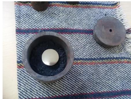
**Figura 3.15.** Contenedor de acero inoxidable con las muestras de acero.
