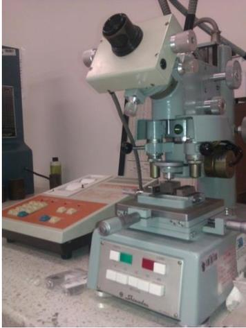
**Figura 3.6.** Microdurómetro Vickers marca Shimadzu. Propiedad del ITESM-CEM.
