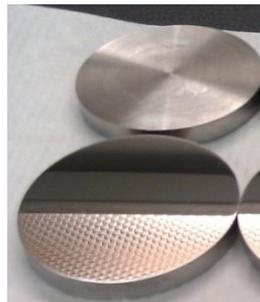
**Figura 3.12.** Acabado de probetas maquinadas y pulidas previa boruración.
