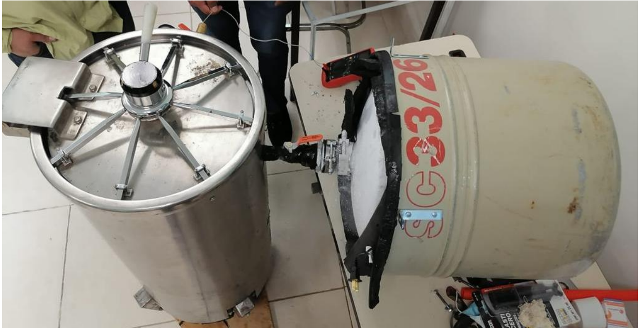
Figura 3.37. Prototipo nuevo crio congelador
