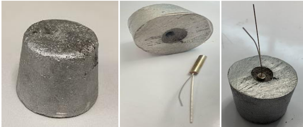
Figura 3.21. Cartucho calefactor y cono de aluminio
