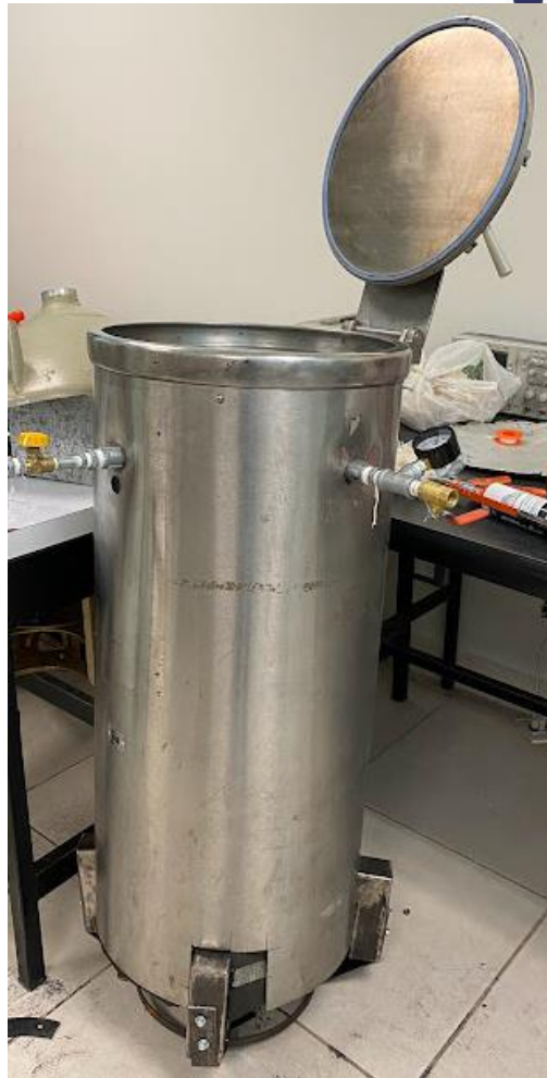
Figura 3.27. Tanque criogénico Fuente: Propia
