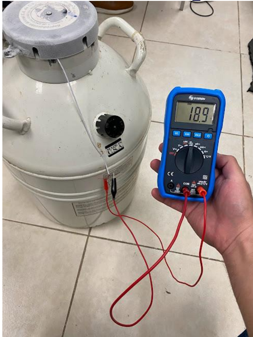
Figura 3.18. Medición de resistencia del nitrógeno líquido por medio de sensor RTD Omega® de tres terminales
