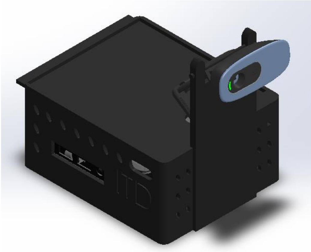
*Figura 58. Diseño CAD del dispositivo armado con carcasa modificada*
