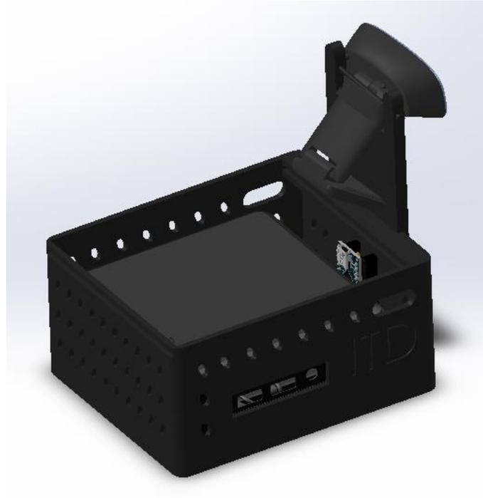
*Figura 59. Diseño CAD de dispositivo con NUC y Arduino Nano*
