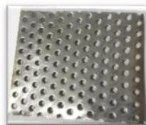
Figura 2.3 Electrodo de acero
