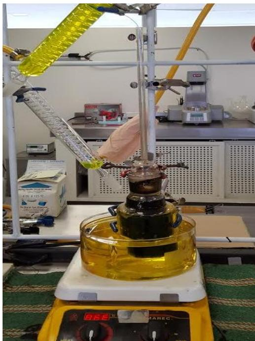
Figura 2.3 Celda de Amott empleada en el proceso de imbibición.
