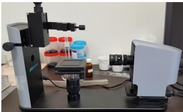
Figura 2.6 Tensiómetro Attension, Theta Lite 101.
