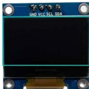
Figura 17. Pantalla OLED para presentación de información.
