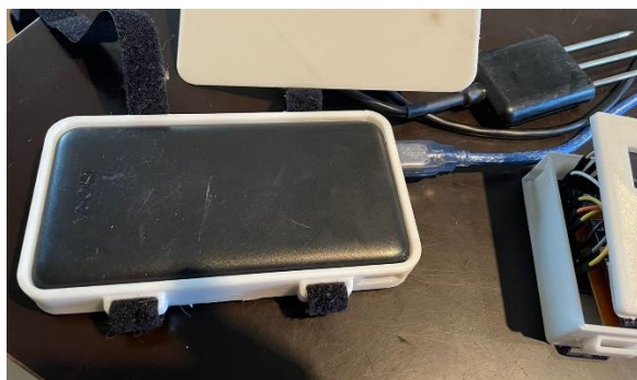
Figura 27. Montaje de batería portátil dentro de su módulo prototipado.
