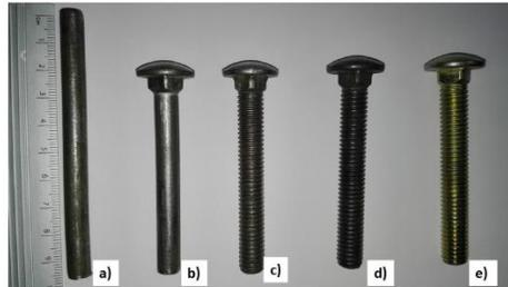
Figura 3.3. Alambre y pasos de forjado de tornillos: a) corte y enderezado del alambre, b) cuadro de cabeza y cabeza, c) roscado, d) tornillo con temple y revenido y e) tornillo tropicalizado
