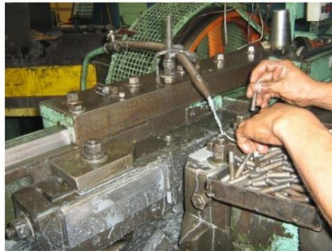
Figura 2.6. Máquina de recalado de pernos fabricados por varias funciones de golpeo en serie [17].
