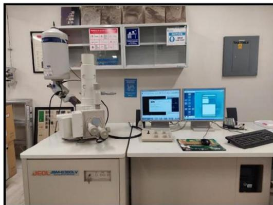
*Figura 35 Microscopio Electrónico de Barrido (SEM)*
