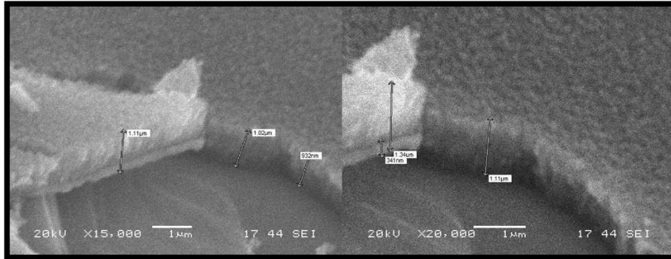
Figura 43 Espesor del recubrimiento de Nitruro de Titanio.
