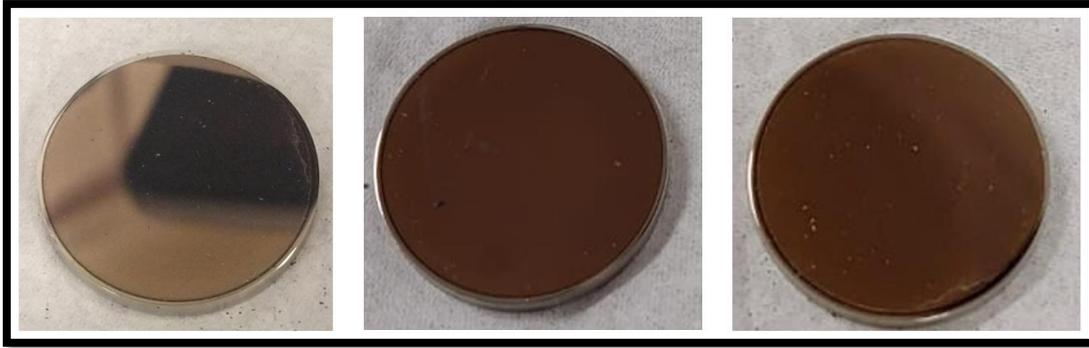
Figura 33 Sustratos de acero inoxidable 316L después de ser depositados con Ti/TiN por PVD.
