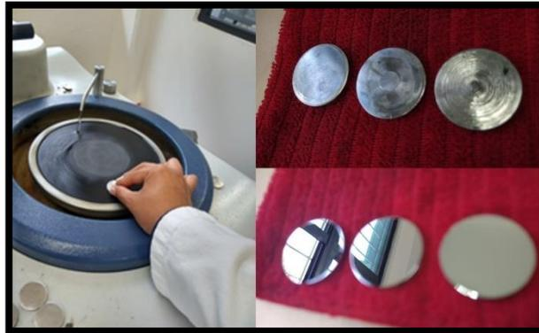
Figura 28 Preparación de las muestras. De lado superior derecho muestras en desbaste y del lado inferior derecho después de ser pulidas.
