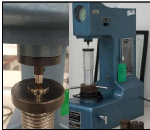
Figura 37 Durómetro para ensayos tipo Rockwell marca Louis Small. De lado izquierdo se observa la carga aplicada a una de las muestras.
