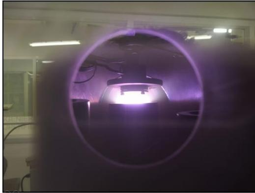
*Figura 31 Muestra sobre magnetrón.*
