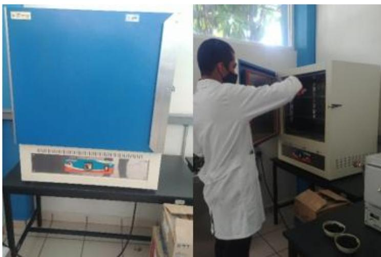
Figura 3.15 Eliminación de la humedad remanente en el carbón de nopal a 110°C (Tomado por: Torres, 2022)
