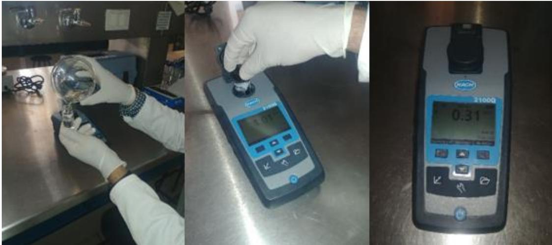
Figura 3.33 Procedimiento de medición de la turbidez del agua (Tomada por: Torres, 2021)
