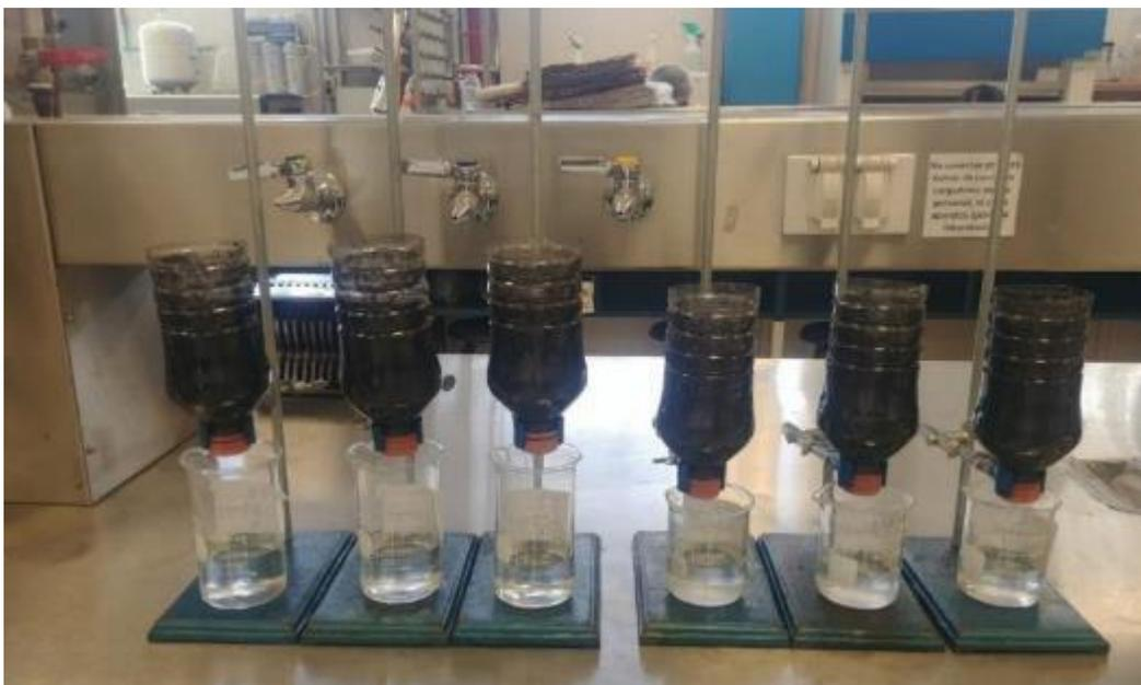
Figura 3.31 Filtración de agua con arsénico 0.025 mg/L y 0.01 mg/L, usando carbón activado de nopal (Tomada por: Torres, 2021)
