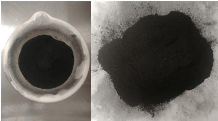
Figura 3.20 Carbón activado de nopal en polvo (Tomado por: Torres, 2022)
