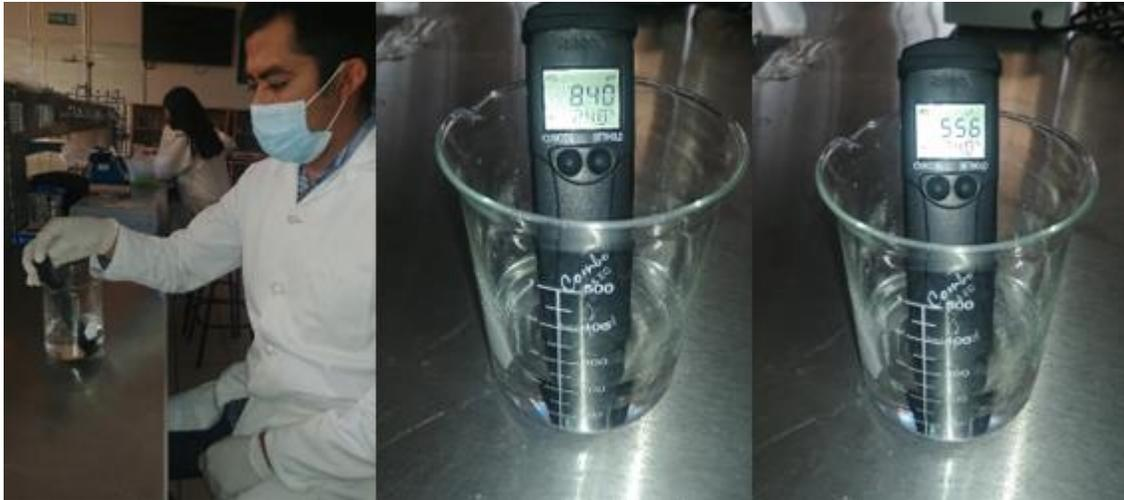
Figura 3.34 Medición de pH y conductividad usando el medidor de bolsillo HI98130
