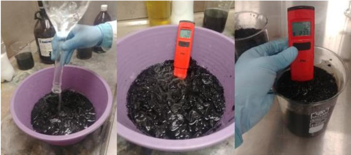
Figura 3.17 Lavado del carbón activado de nopal con NaOH 1 N (Tomado por: Torres, 2022)
