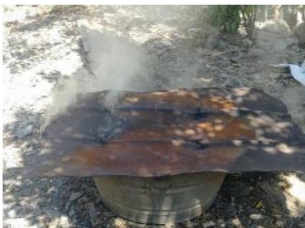
Figura 3.11 Reducción de oxígeno en la calcinación de la biomasa (Tomado por: Torres, 2022)
