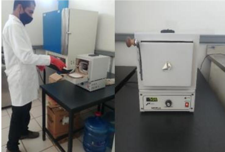
Figura 3.16 Activación del carbón de nopal a 500°C (Tomado por: Torres, 2022)
