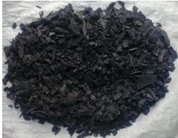
Figura 3.12 Carbón de nopal obtenido de la calcinación (Tomado por: Torres, 2022)
