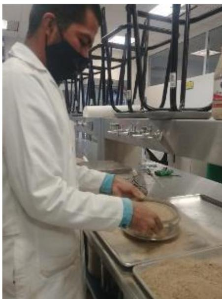
Figura 3.8 Tamizado de la biomasa de nopal triturada (Tomado por: Torres, 2021)
