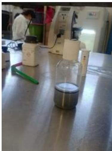
Figura 3.28 Dejar reposar la muestra 20 minutos y agitar dos o tres veces en dicho tiempo (Tomada por: Torres, 2021)
