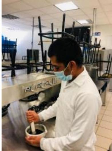
Figura 3.19 Pulverizado del carbón activado de nopal (Tomado por: Torres, 2022)
