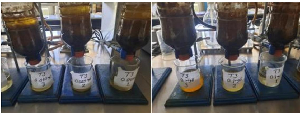
Figura 3.32 Filtración de agua con arsénico 0.025 mg/L y 0.01 mg/L, tratamiento 3
