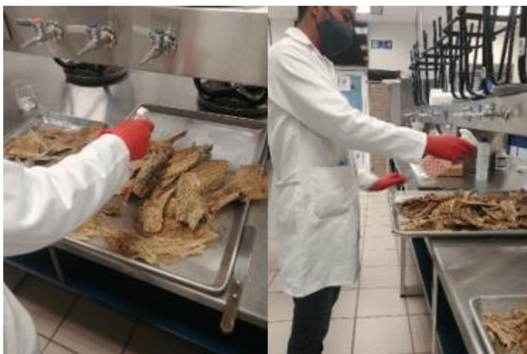
Figura 3.4 Aplicación de ácido clorhídrico 1% a biomasa seca de nopal (Tomado por: Torres, 2021)
