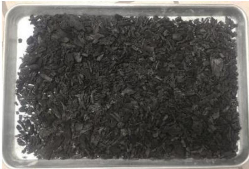
Figura 3.18 Carbón activado de nopal seco (Tomado por: Torres, 2022)
