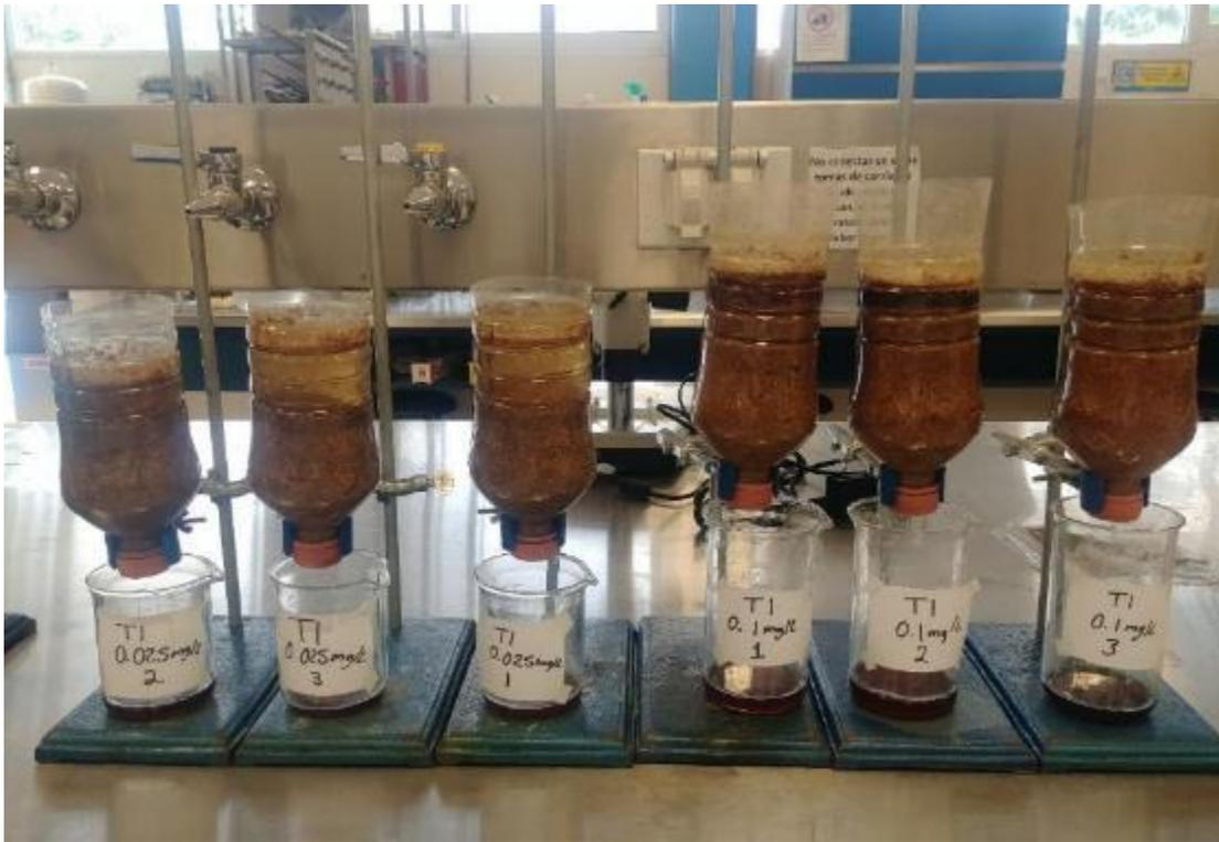
Figura 3.30 Filtración de agua con arsénico 0.025 mg/L y 0.01 mg/L, usando biomasa seca de nopal (Tomada por: Torres, 2021)
