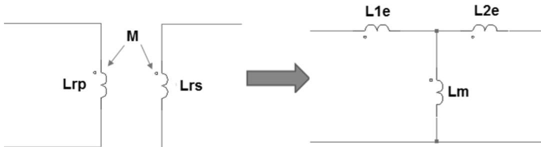
Figura 18 Modelo equivalente de las bobinas acopladas
