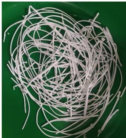
Figura 7.12. Filamentos obtenidos con la mezcla Acetato 12.5%/PVP 5%.
