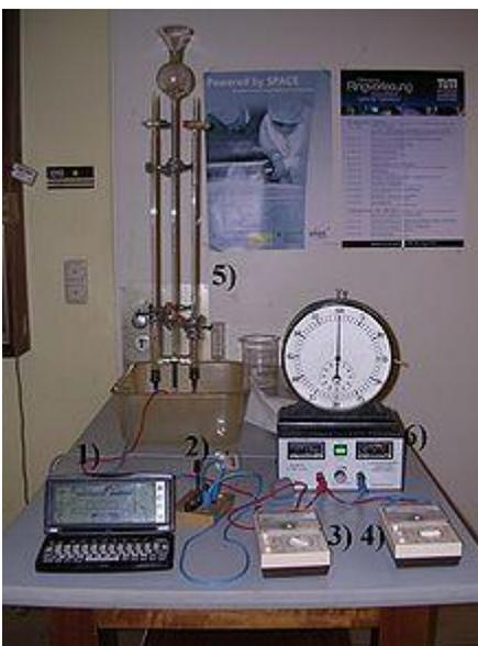
Ilustración 15 Aparato para electrolisis del agua y otras disoluciones con matracas para recogida de los gases liberados.
