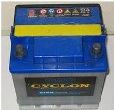
Ilustración 12 Batería de ácido-plomo, de un automóvil.
