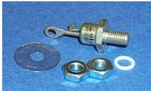
**Ilustración 25 Diodo Rectificador**
