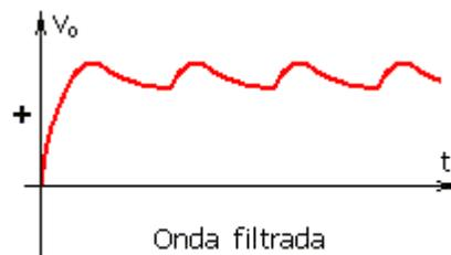
Ilustración 22 Filtrado para atenuar el rizado de la tensión rectificada mediante un condensador, conformando un circuito RC (filtro de condensador).
