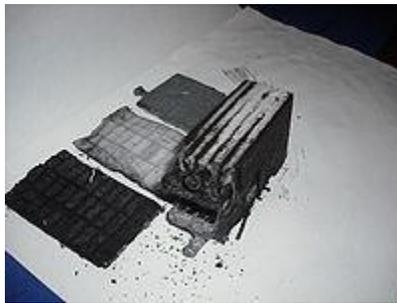
**Ilustración 14** Batería de ácido-plomo con celdas de fieltro de vidrio absorbente, mostrando aparte los dos electrodos y, en medio, el material de vidrio absorbente que evita derrames del ácido.
