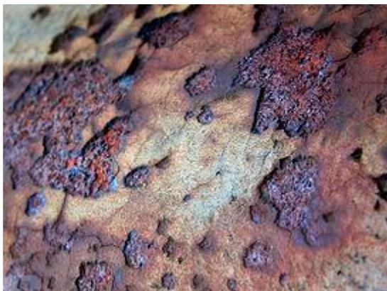
Ilustración 7 Trozo de metal oxidado (corroído)
