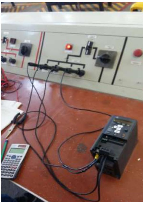
**Figura 4.18.** Programación de Variador de Velocidad General Electric.
