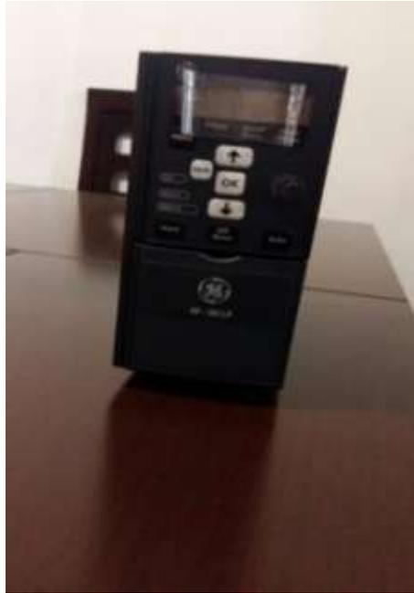
**Figura 2.14.** Variador de velocidad General Electric AF-60 LP.
