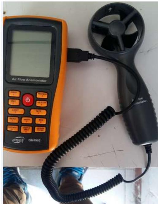
**Figura 2.19.** Anemómetro Digital Benetech Gm 8902.
