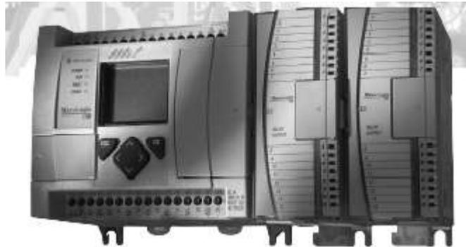
**Figura 2.11.** Controlador Lógico Programable Micrologix 1100.
