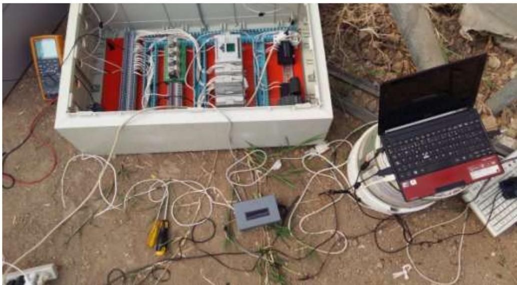
**Figura 5.9.** Pruebas control PID del ventilador.
