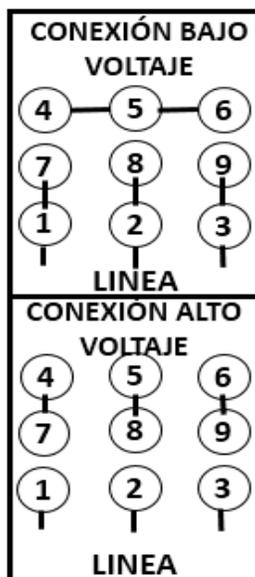
**Figura 4.16.** Conexiones bajo y alto voltaje de Motor Trifásico de Inducción Abierto.
