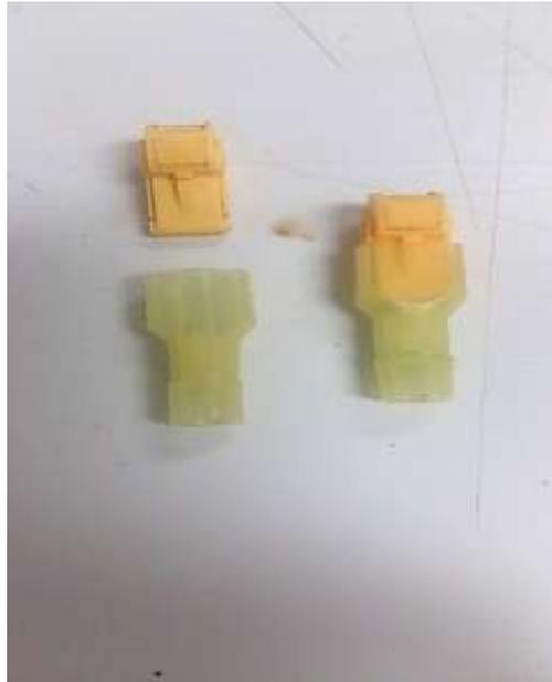
**Figura 2.24.** Conector rápido.
