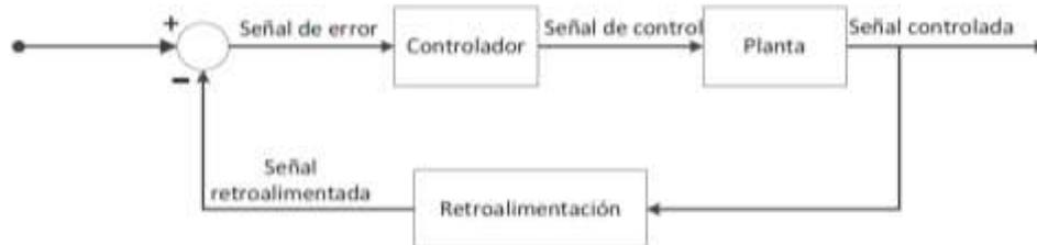
**Figura 2.9.** Sistema de control retroalimentado
