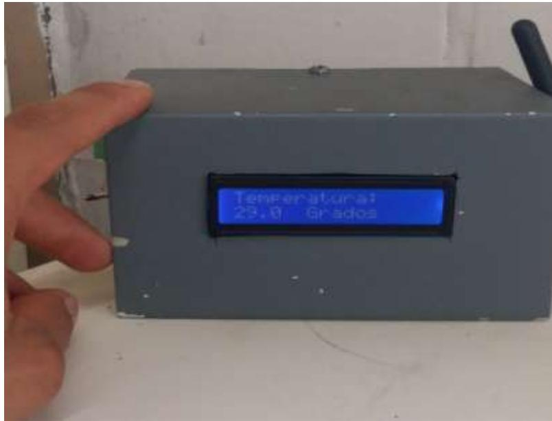
**Figura 5.8.** Recepción de temperatura mediante la caja receptora.
