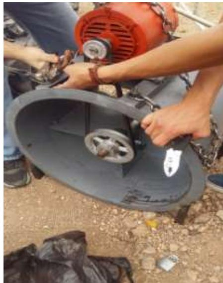
Figura. 1. Sujeción de Motor Trifásico - Ventilador Tubular.
