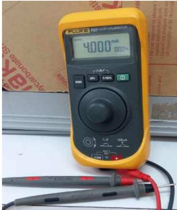
**Figura 2.20.** Calibrador de lazos Fluke 707.
