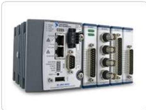
**Figura 3.1.** Controlador de Automatización Programable.
