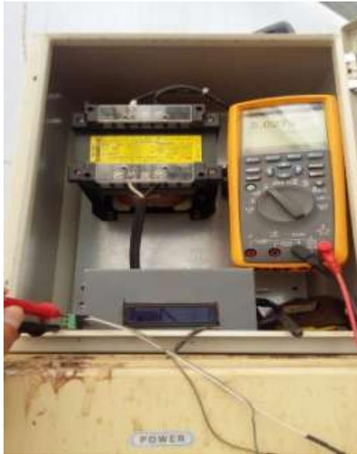
**Figura 5.6.** Comprobación de tensión en salida de transmisor en operación.
