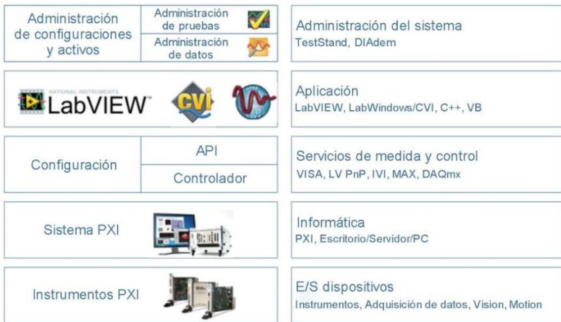
**Figura 3.2** Arquitectura completa de un sistema PXI
