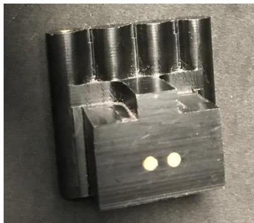
**Figura 4.13** Fixture para la prueba de corriente de DUT.
