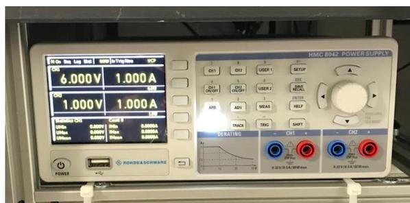
**Figura 4.17** Fuente y multímetro digital.
