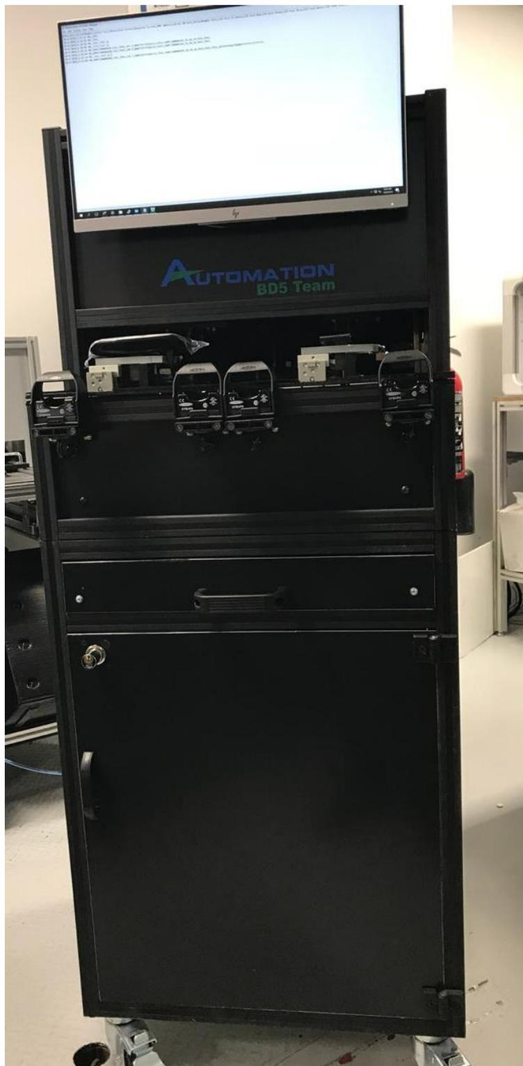
**Figura 5.3** Estación para FVT del P450 de Landis.
