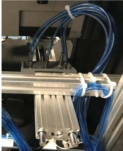
**Figura 4.10** Actuadores neumáticos para la prueba táctil, unidad Golden.
