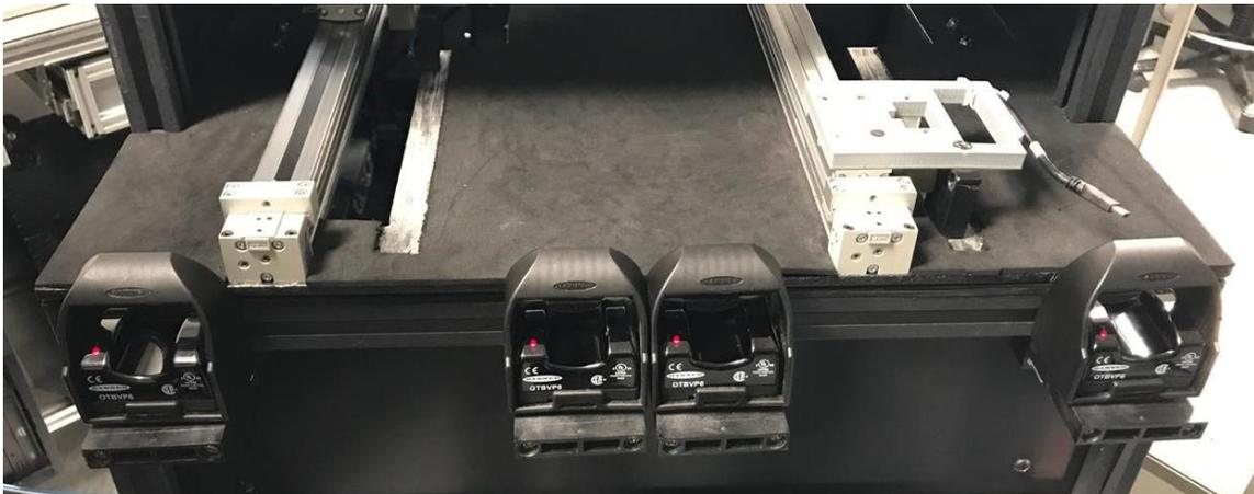
**Figura 5.2** Sensores capacitivos táctiles de activación, fixture y cilindros neumáticos de posición.
