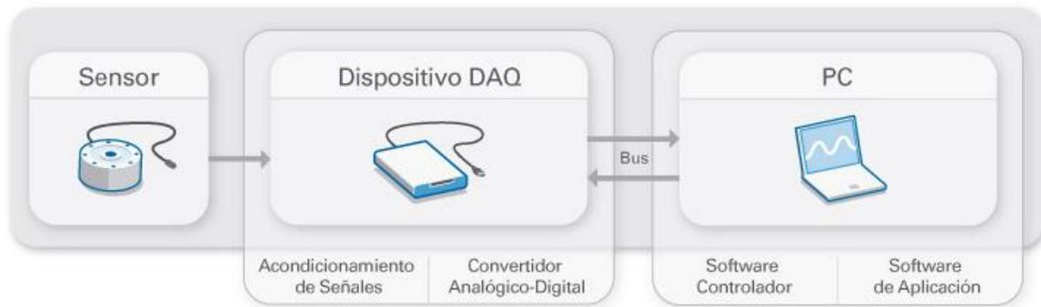
**Figura 2.3** Sistema de adquisición de datos.
