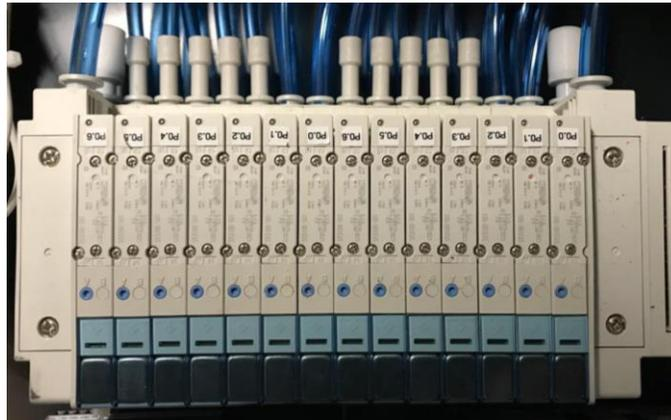
**Figura 4.8** Manifold y conexiones.
