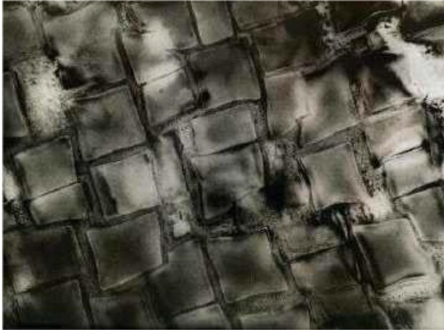
Figura 2.8: Microestructura de la fase gamma prima ( $\gamma'$ ) incrustada en una matriz de fase gamma ( $\gamma$ ).
