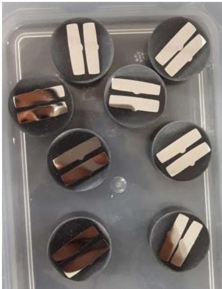
Figura 4.19: Muestras terminadas efecto espejo.
