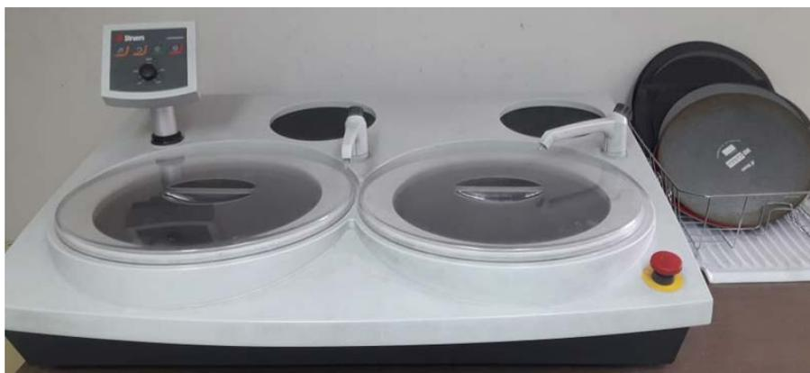
Figura 4.16: pulidora automática usada para el desbaste de las muestras.
