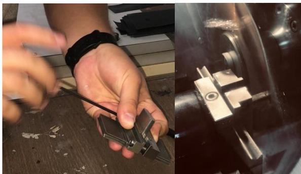
Figura 4.12: Izq: Montando la muestra; Der: Proceso de corte de la muestra.
