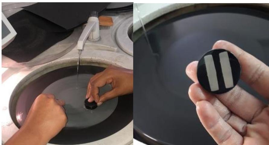
Figura 4.17: Izq: Realizando el desbaste en presencia de agua; Der: Desbaste terminado.
