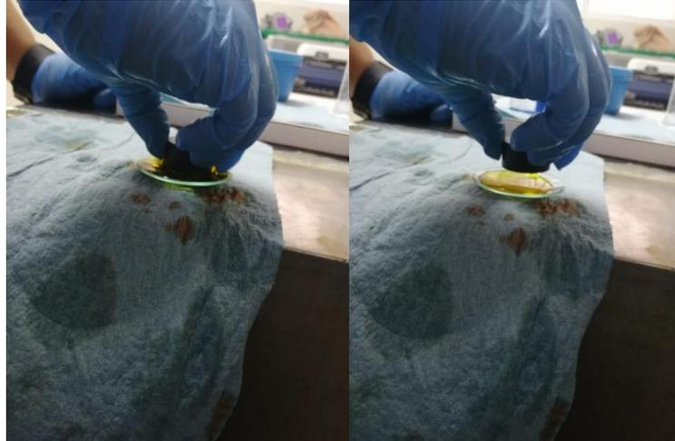
Figura 4.20: Sumergiendo la muestra en el reactivo Kaling's No.2.
