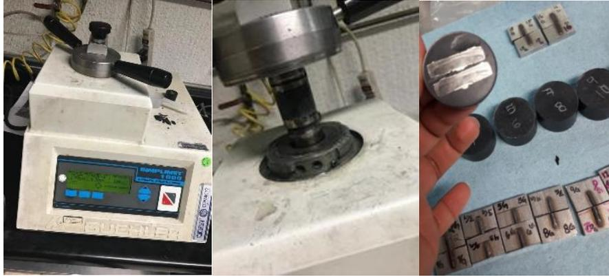
Figura 4.13: Proceso de montaje de las muestras.
