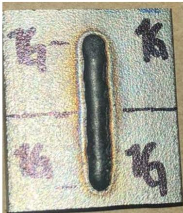
Figura 4.11: Pieza marcada e identificada para el corte.
