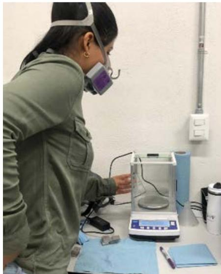
Figura 4.7: Tarando la báscula con el peso del vaso precipitado vacío que se encuentra en la posición 2.
