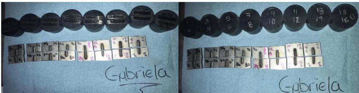
Figura 4.15: Muestras montadas e identificadas. Proceso de montaje finalizado con 8 piezas de baquelita.
