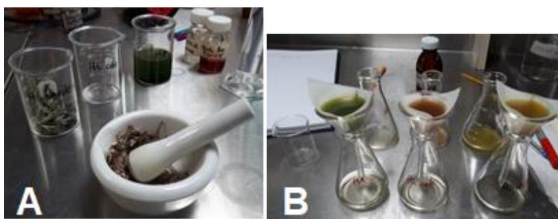
**Figura 3.** Preparación de muestra a) Triturado de muestra vegetal, b) solventes utilizados.
