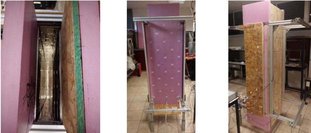
*Figura 3.8. Armado de la chimenea solar con envoltentes desarrolladas*
