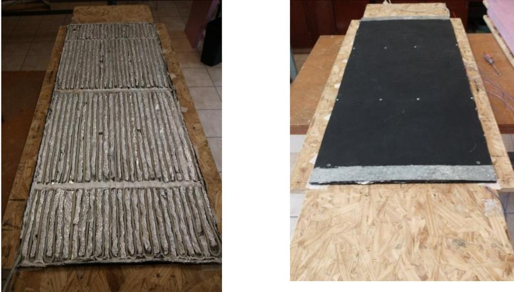
*Figura 3.7. Montaje de placa absorbente*
