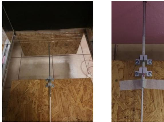
**Figura 3.18.** Ubicación de sensor de velocidad de aire
