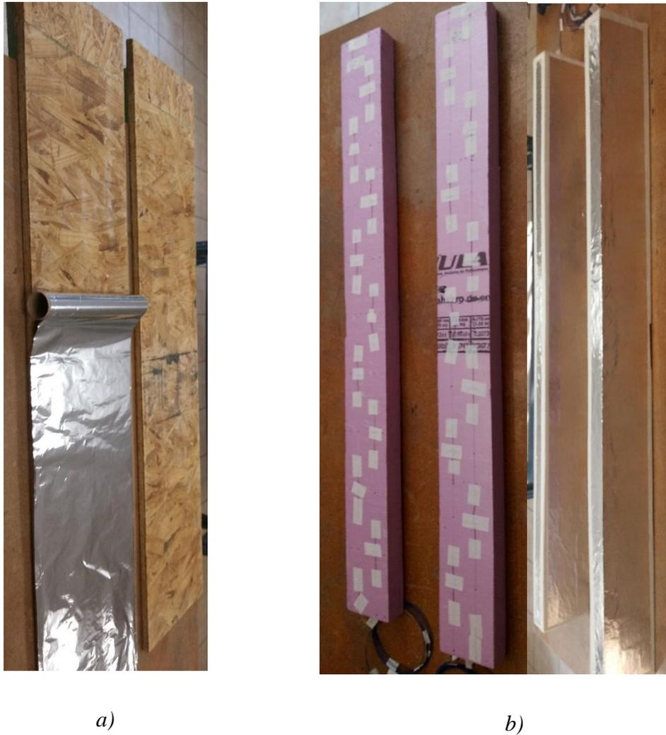
**Figura 3.6.** Aislantes en los costados: a) corte de madera, b) poliestireno expandido
