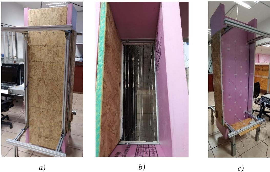
**Figura 3.19** Vistas del armado de la chimenea con instrumentación: a) lateral derecho, b) superior, c) lateral izquierdo
