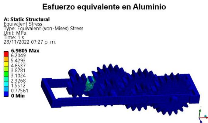
Figura 82: Esfuerzo equivalente en tren de aluminio.
