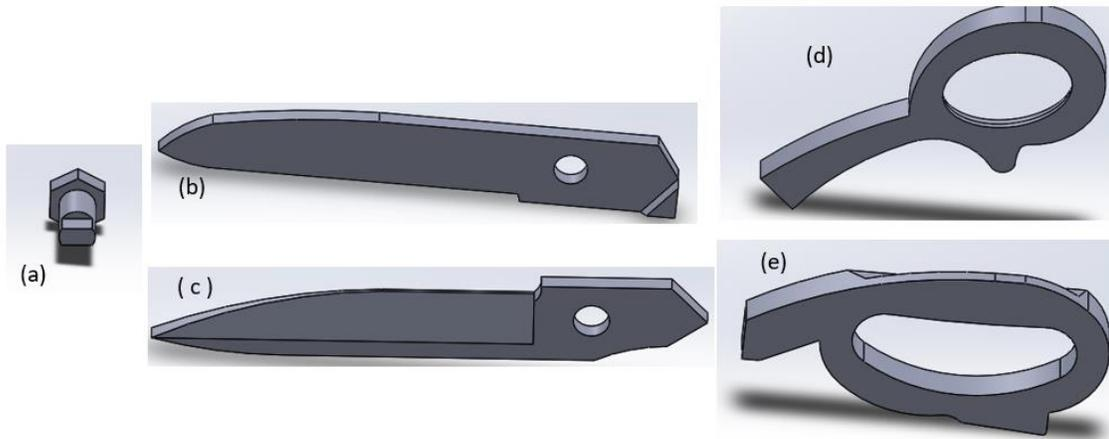
Figura 11: Partes de las tijeras a) Perno b) Cuchilla superior c) Cuchilla inferior d) Mango superior e) Mango inferior.
