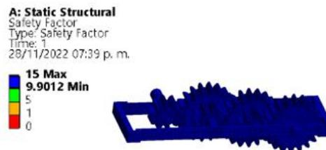
Figura 89: Factor de seguridad en tren de PLA
