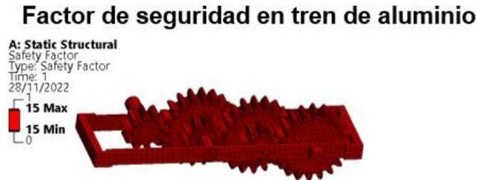
Figura 90: Factor de seguridad en tren de aluminio.
