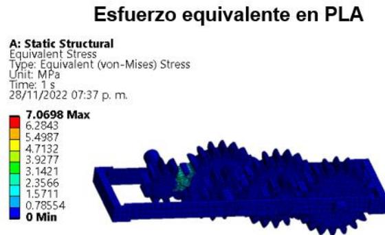
Figura 81: Esfuerzo equivalente en tren de PLA.
