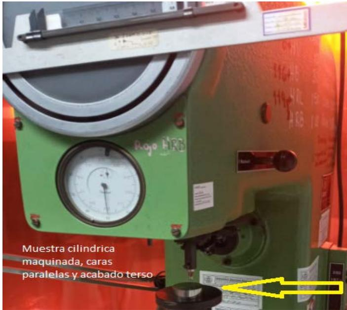
Figura 19. La siguiente imagen muestra un durómetro universal en el cual se puede medir durezas en materiales metálicos DRA, DRB, DRC, DV y DB.
