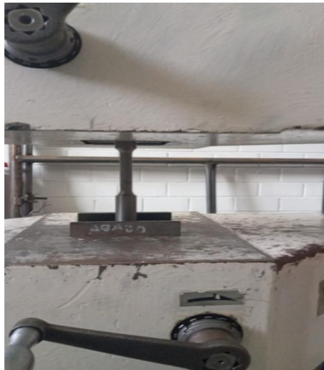
Figura 22. Muestra la probeta cilíndrica sobre el yunque del durómetro, las características de una probeta son de tener una superficie con acabado terso y de tener caras paralelas con la finalidad de evitar el bamboleo, del método de evaluación se sugiere a temperatura ambiente, limpieza absoluta y eliminar al máximo golpes y vibraciones, así como realizarse a temperatura ambiente.
