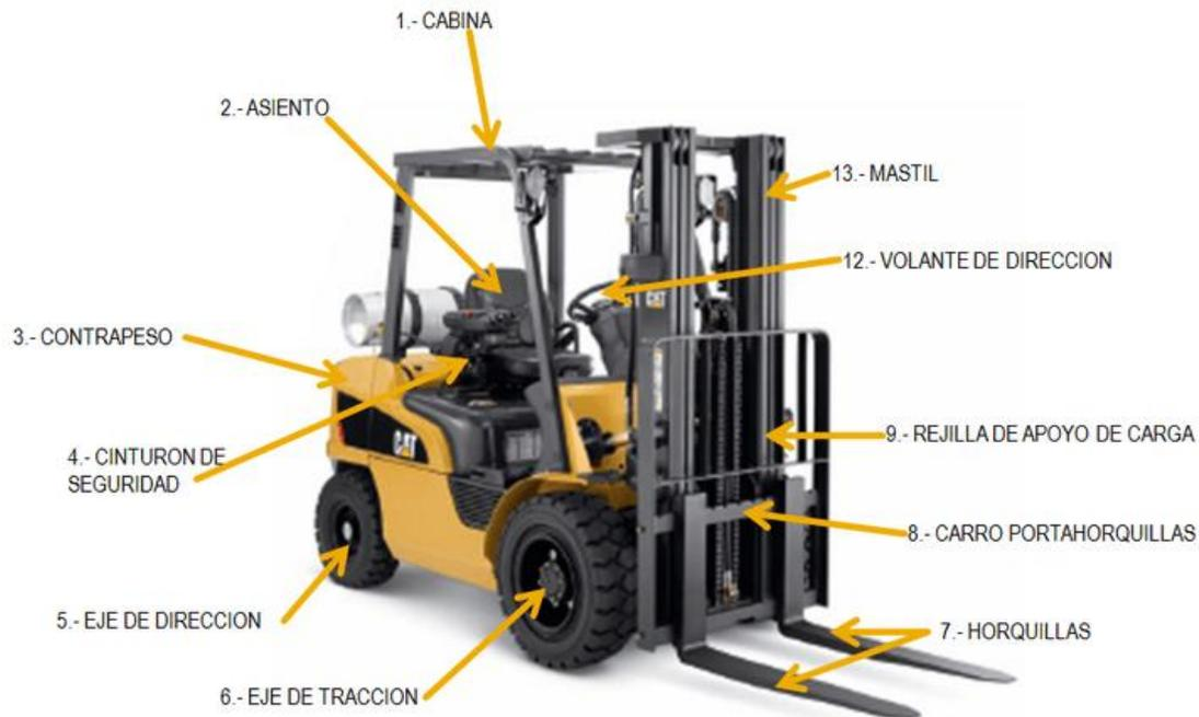
*Nota:* Componentes generales de un montacargas.
