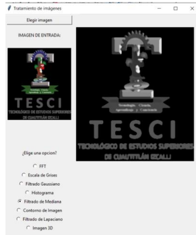
Figura 24: Resultado de tratamiento de Filtrado de Mediana
