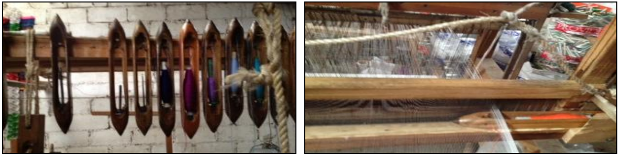
Figura 1.3.6 Proceso de colocar el hilo en las lanzaderas
