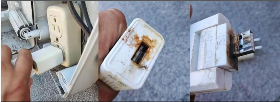
Figura 24 DTU con restos de oxidación (inservible)
