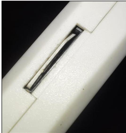
Figura 25 Sim con rastros de humedad y oxidación.
