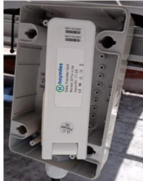
*Ilustración 11 correcta orientación del DTU*
