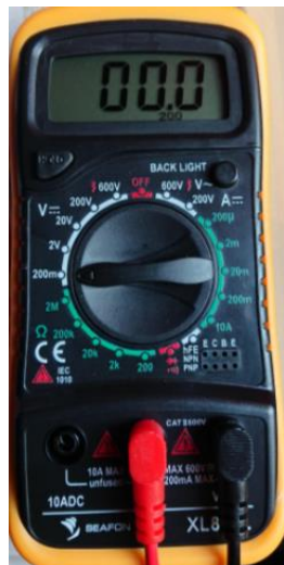
Figura 33: Encendido de voltímetro a 200 mV
