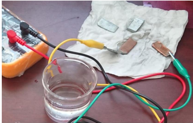
Figura 32: Conexión de caimanes del multímetro a las placas de Zinc y Cobre.
