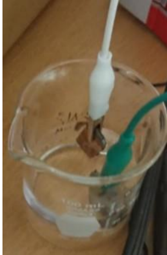
Figura 34: Sumergido de las celdas de Zinc y Cobre en agua con sal común.
