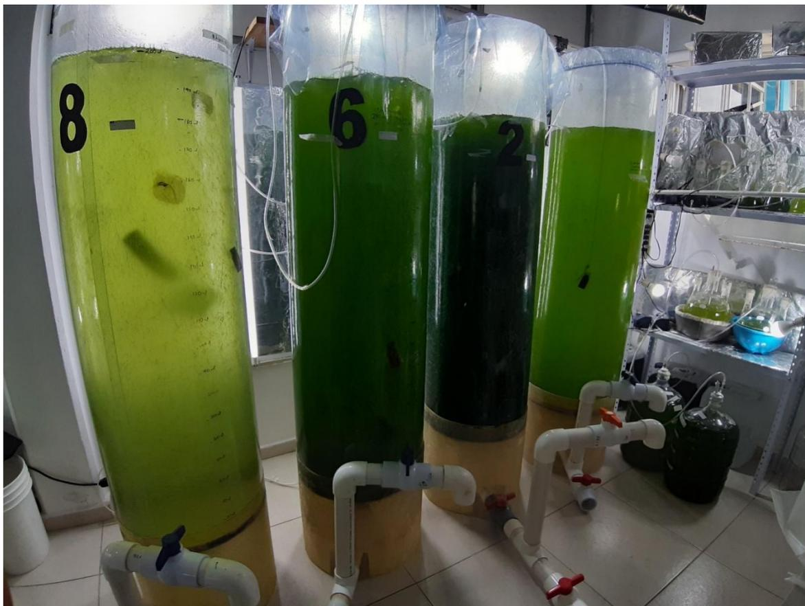
Fig. 21 Cultivo de microalgas en fotobiorreactores de 200 L.
