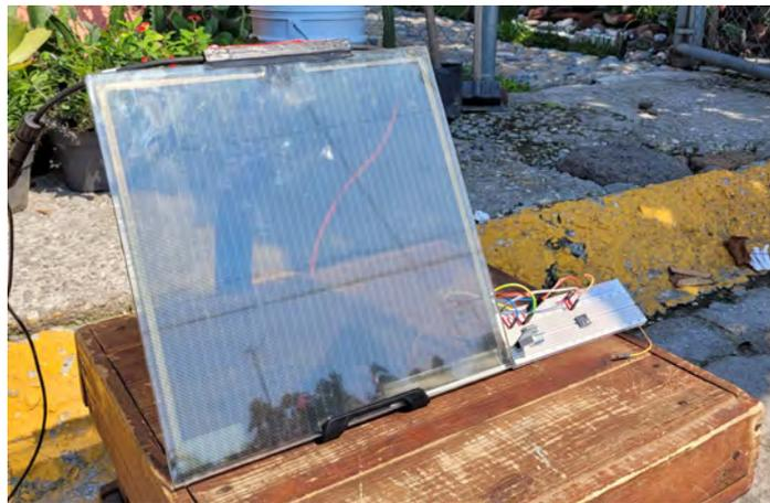
Figura 3.5: Pruebas eléctricas de una CST en irradiancia solar.
