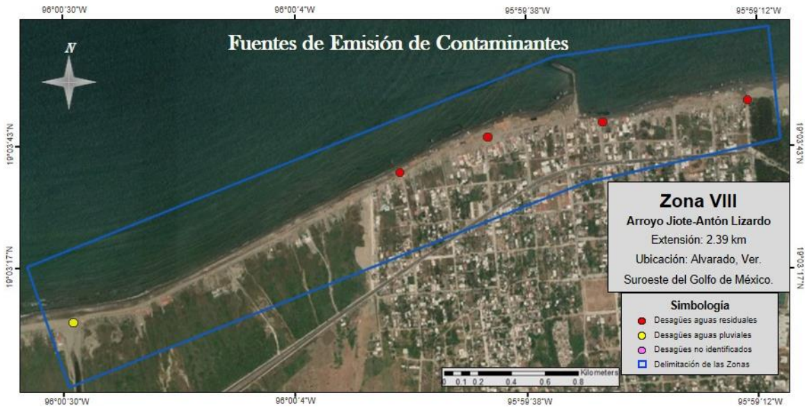
Figura 15. Delimitación e identificación de Fuentes de Emisión de Contaminantes que descargan aguas pluviales y aguas residuales directamente en las playas pertenecientes a la Zona VIII.
