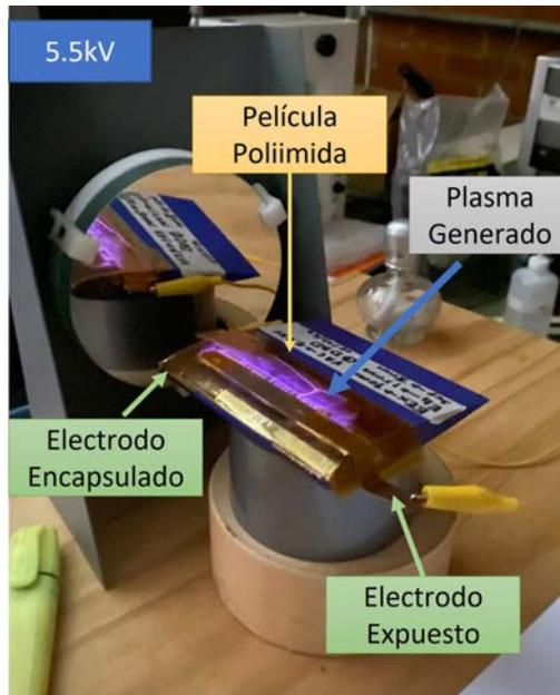
**Figura 5.13.** Actuador de plasma en perfil aerodinámico con poliimida como material dieléctrico
