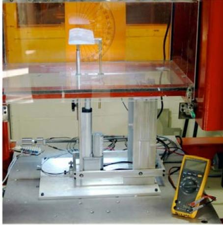
Figura 1.4. Balanza aerodinámica [21]
