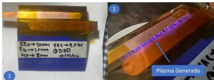
**Figura 5.11.** Actuador de plasma instalado en un perfil NACA-4412 de 10 cm de cuerda, usando electrodos de cobre de 0.20 mm de espesor
