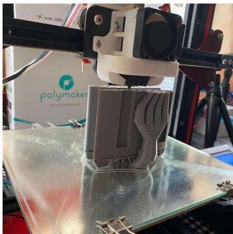
**Figura 5.15.** Impresión 3D del perfil aerodinámico NACA-4412
