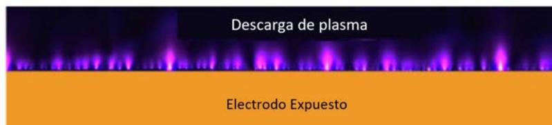
Figura 2.10. Plasma débilmente ionizado en el electrodo encapsulado [34]
