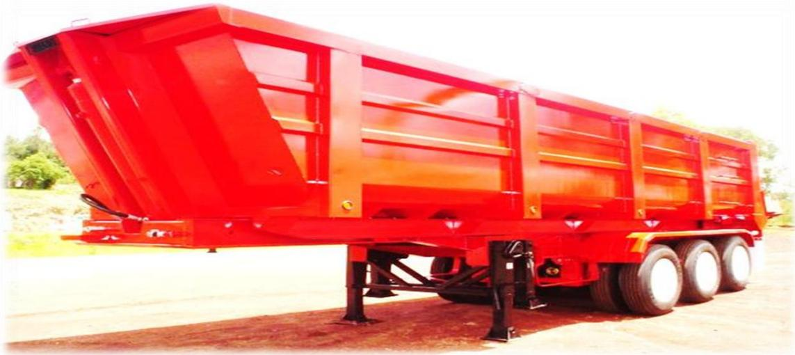
Figura 2 Semirremolque tipo volteo 30m<sup>3</sup> (Fuente. CyRVR)
