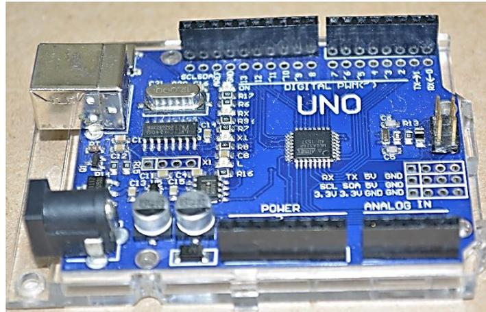
**Figura 3. Micro controlador Arduino-Uno.**
