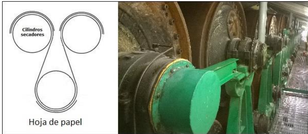
Figura 1.31. Sección de cilindros metálicos secadores.
