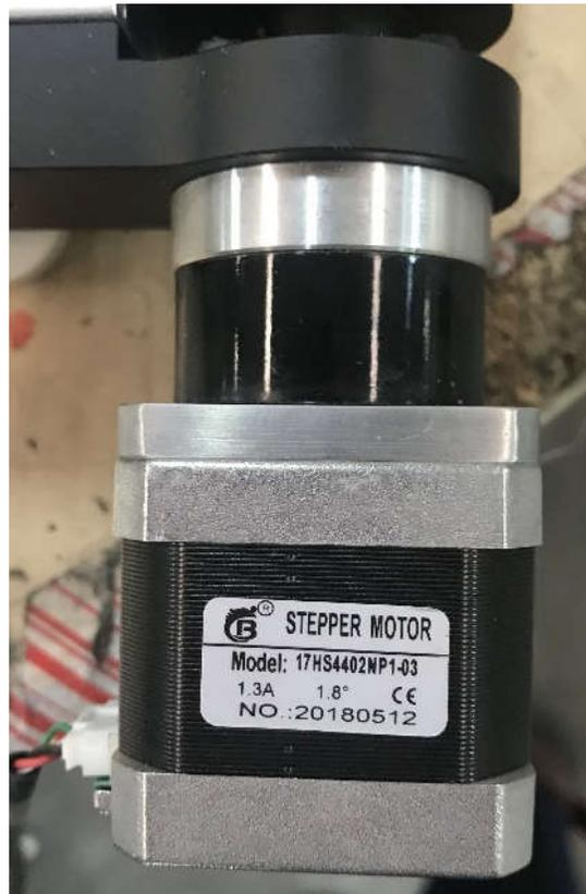
Figura 25. Motor a pasos de la banda transportadora.
