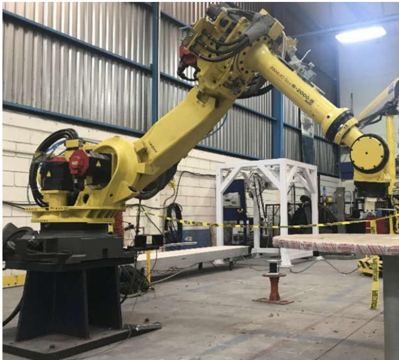
Figura 20. Robot manipulador FANUC R-2000iB/165F.
