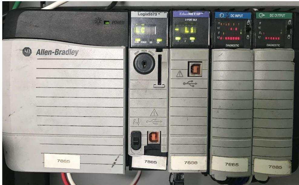
Figura 22. PLC ControlLogix 5573 con módulos de I/O.
