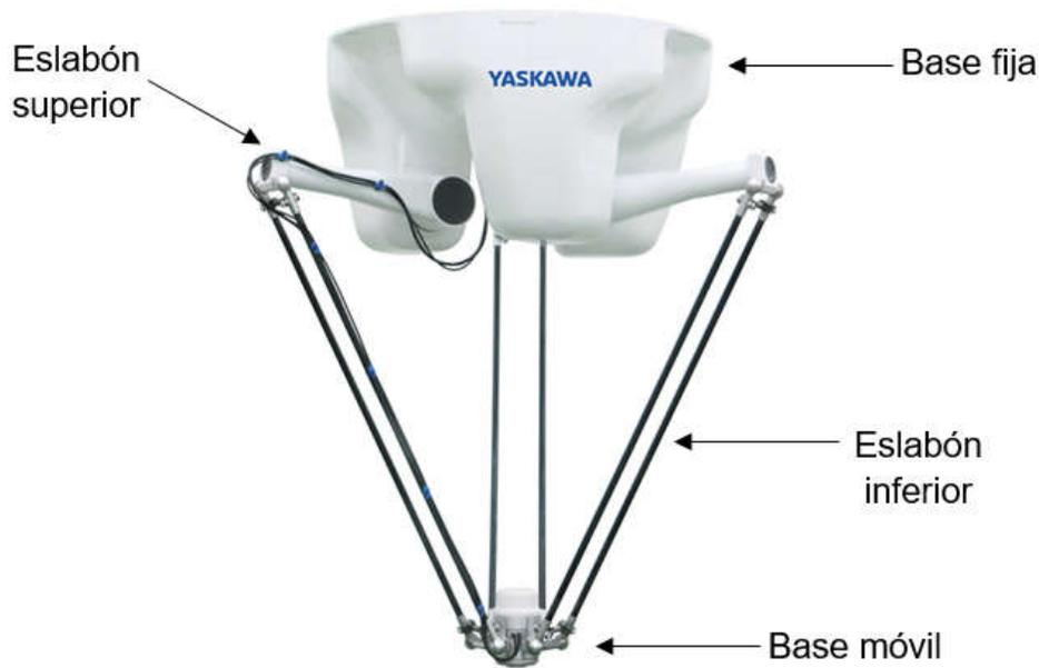
Figura 6. Estructura del robot delta.
