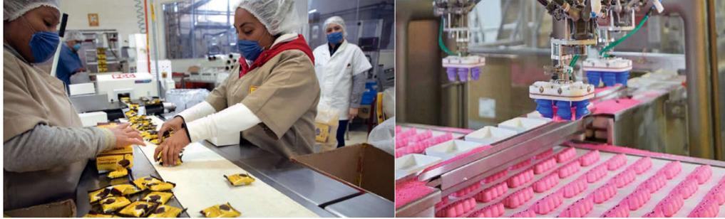
Figura7. Pick and place manual y robotizado.
