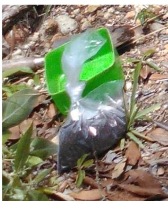
**Figura 7.** Núcleo extractor de muestra de suelo de 15x15 cm y bolsa de polietileno con muestra de suelo debidamente etiquetada.
