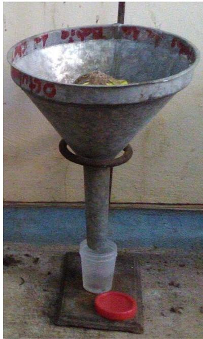
**Figura 8.** Método del embudo de Berlesse-Tullgren modificado utilizado para procesar las muestras procesadas.
