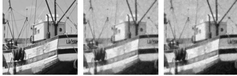
Figura 3.22: (a) Imagen Original. (b) Recuperación de n=25000 mediciones corruptas con ruido Gaussiano. (c) Recuperación de n=25000 mediciones corruptas por redondeo de error (Candes et al., 2006).
