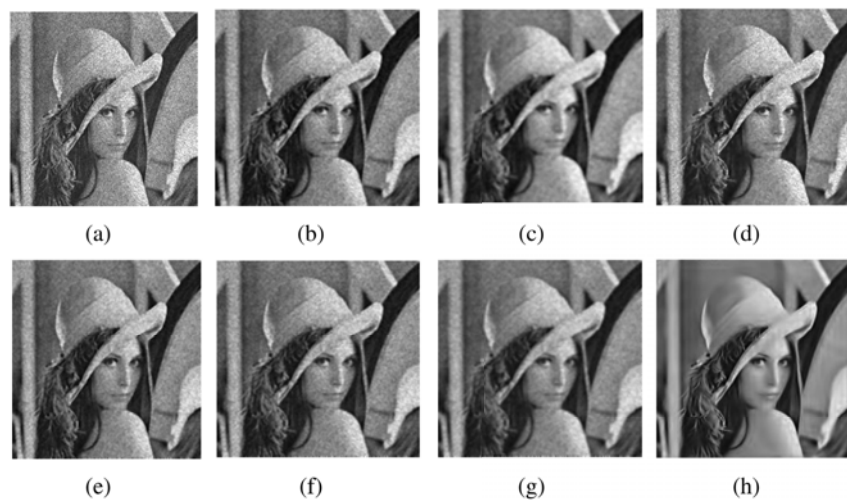
Figura 3.5: Imágenes de resultado usando varios filtros. (a) Lena con ruido, (b) Lee, (c) Frost, (d) Difusión anisotrópica, (e) Sigma, (f) Difusión Lee, (g) Difusión Frost y (h) Filtrado propuesto (Sivaranjani et al., 2019).
